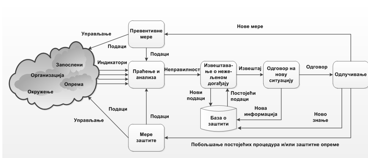
Слика 6.14. Модел управљања нежељеним догађајима са генерисањем нових података, информација и знања, и иницирањем акција
