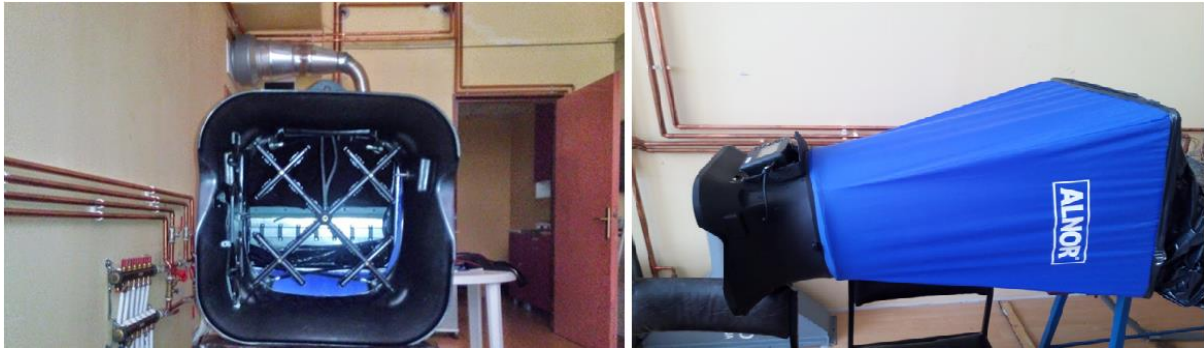
Слика 3.7 Постављање балометра на излазу из канала
