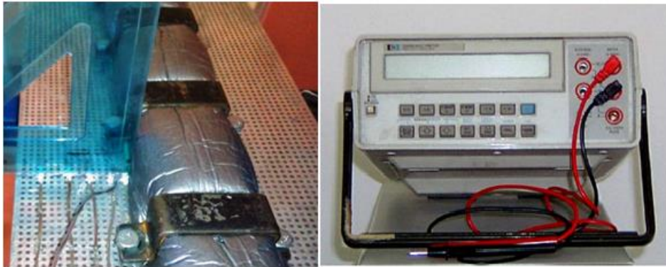
Слика 3.5 Мерна плоча и милivolтметар Hewlett-Packard 3468A
