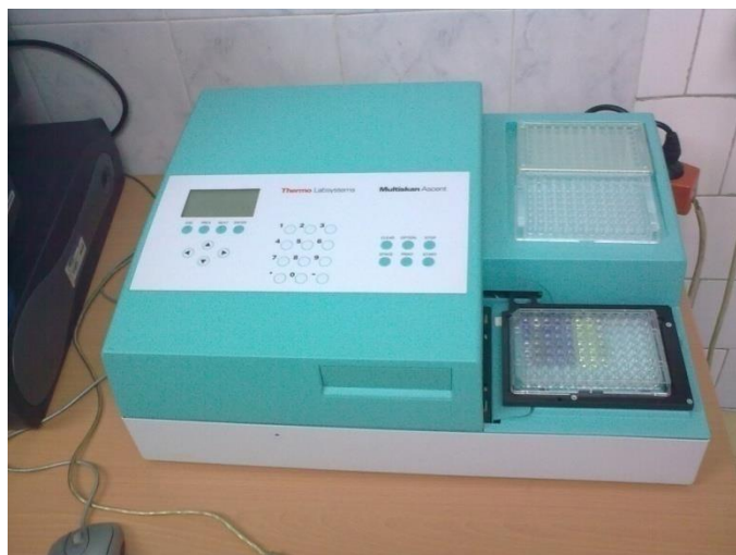
Slika 13. Višekanalni spektrofotometar Multiskan Ascent No354, Thermo Labystems, Finska Institut za biomedicinska istraživanja Medicinskog fakulteta u Nišu.
