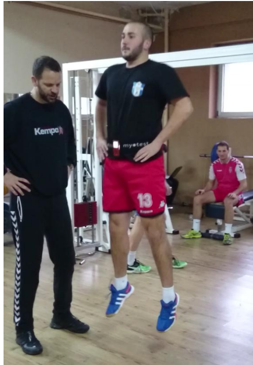
Слика 6. Бежични акцелерометар Myotest и положај испитаника током извођења максималних вертикалних скокова са почучњем
