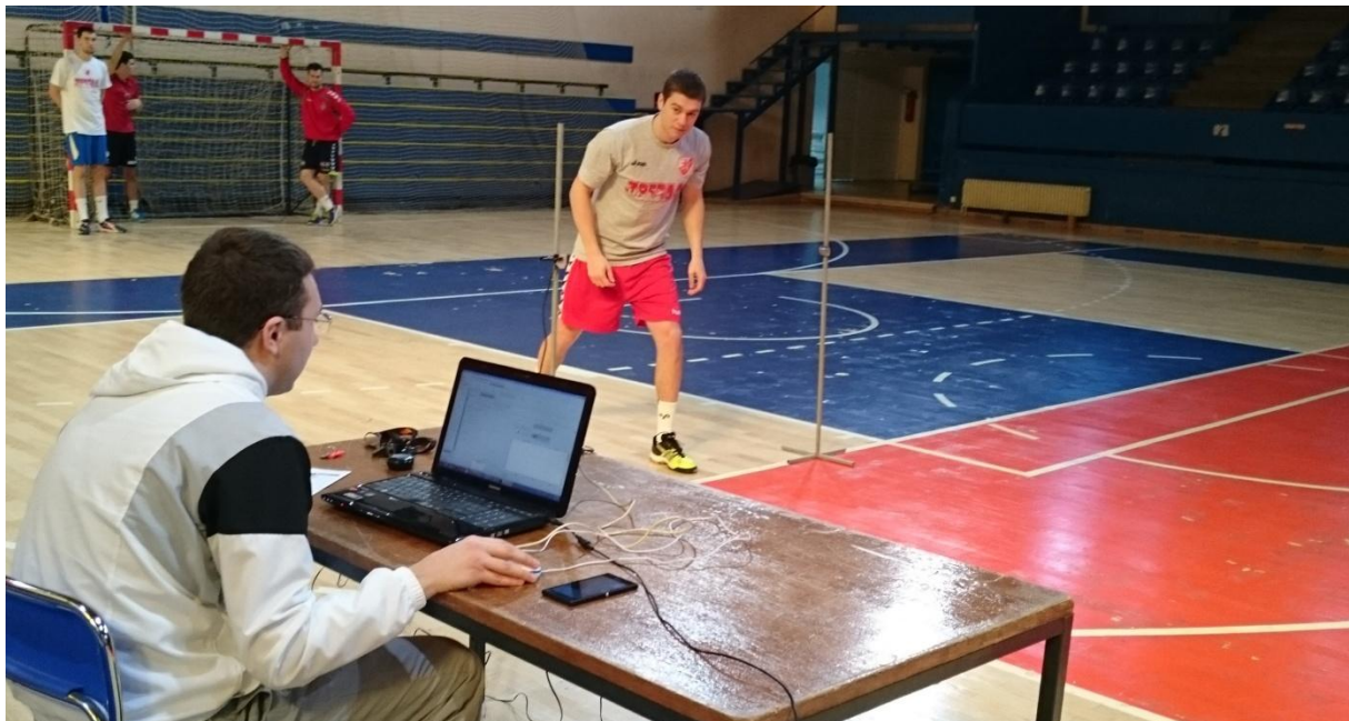
Слика 5. Систем за електронско мерење времена са фото ћелијама Chrono jump и положај испитаника пре почетка теста трчања на 15 m
