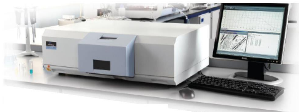
Slika 25. Fluorescentni spektrometar, Perkin Elmer LS 55 (Valtham, Massachusetts, SAD).
