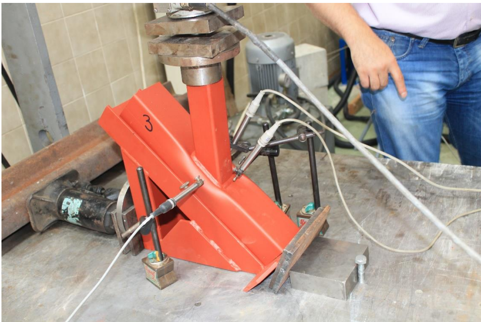
Slika 6.35 – Veza tipa „Y“, uzorak broj 3 – trajne lokalne deformacije
