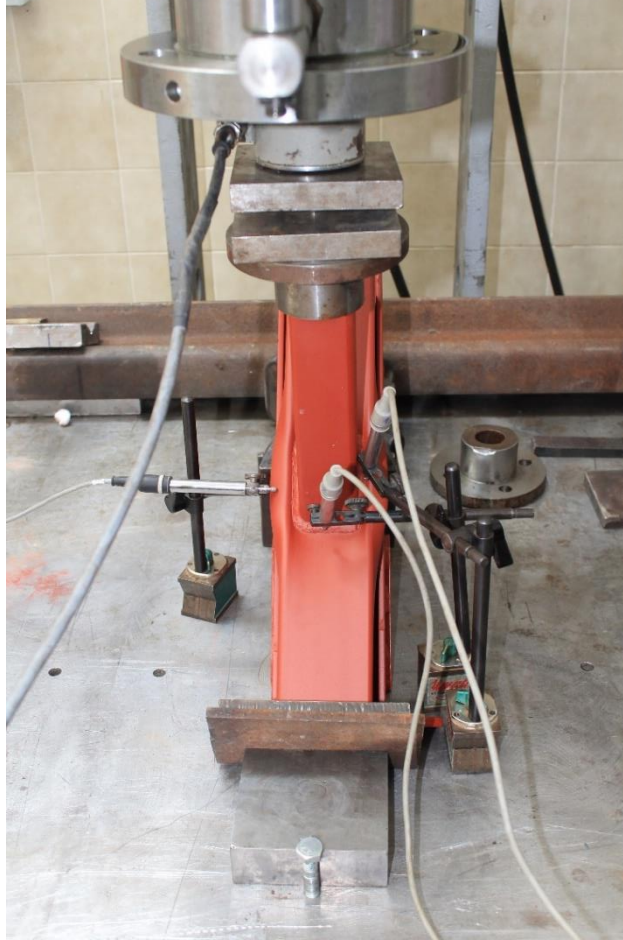
Slika 6.38 – Veza tipa „Y“, uzorak broj 3 – trajne lokalne deformacije
