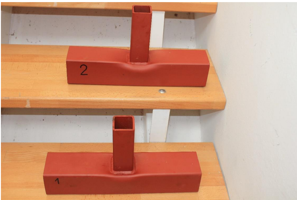
Slika 6.23 – Veza tipa „T“, uzorak broj 1 i 2 – uporedni prikaz trajnih lokalnih deformacija
