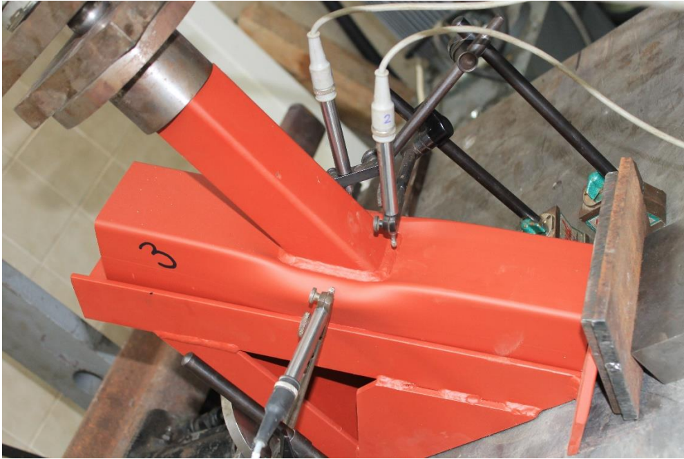
Slika 6.36 – Veza tipa „Y“, uzorak broj 3 – trajne lokalne deformacije
