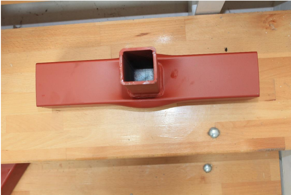
Slika 6.22 – Veza tipa „T“, uzorak broj 2 – trajne lokalne deformacije
