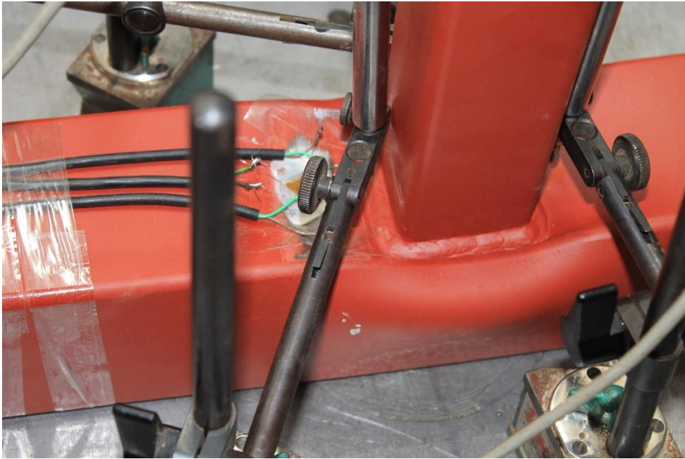
Slika 6.26 – Veza tipa „T“, uzorak broj 3 – trajne lokalne deformacije
