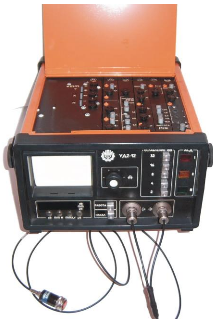
Slika 4.8. Ultrazvučni defektoskop UD2-12 sa kombinovanom ultrazvučnom sondom
