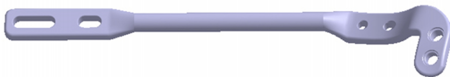
Слика 63. Запремински модел унутрашњег динамичког фиксатора по Митковићу, тип TPL
