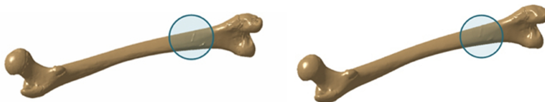
Слика 19. Повећање глаткости полигоналне површине (smoothing)
