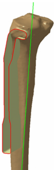
Слика 58. Креирање површине која ограничава контуру фиксатора нормалне на базну раван.
