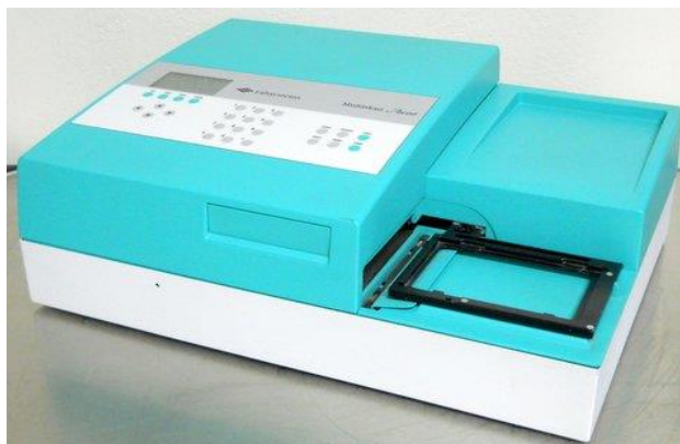
Slika 16. Višekanalni spektrofotometar (Multiscan Ascent, Thermo LabSystems) (preuzeto sa sajta http://www.scientific-equipment.com/equipment-for-sale/microplate/multiskan-ascent-354-microplate-reader?ln=1698 ) 176
