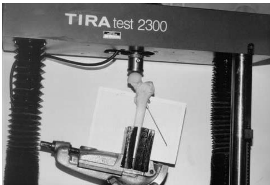
Слика 17. Биомеханичко испитивање самонарезујућих антиротационих завртња у лабораторијама за мерења Машиноског факултета Универзитета у Нишу.
