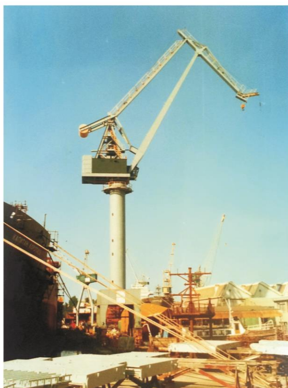
Slika 5.10 Portalno-obrtna dizalica "Pula-2" u brodogradilištu "Uljanik" u Puli.
