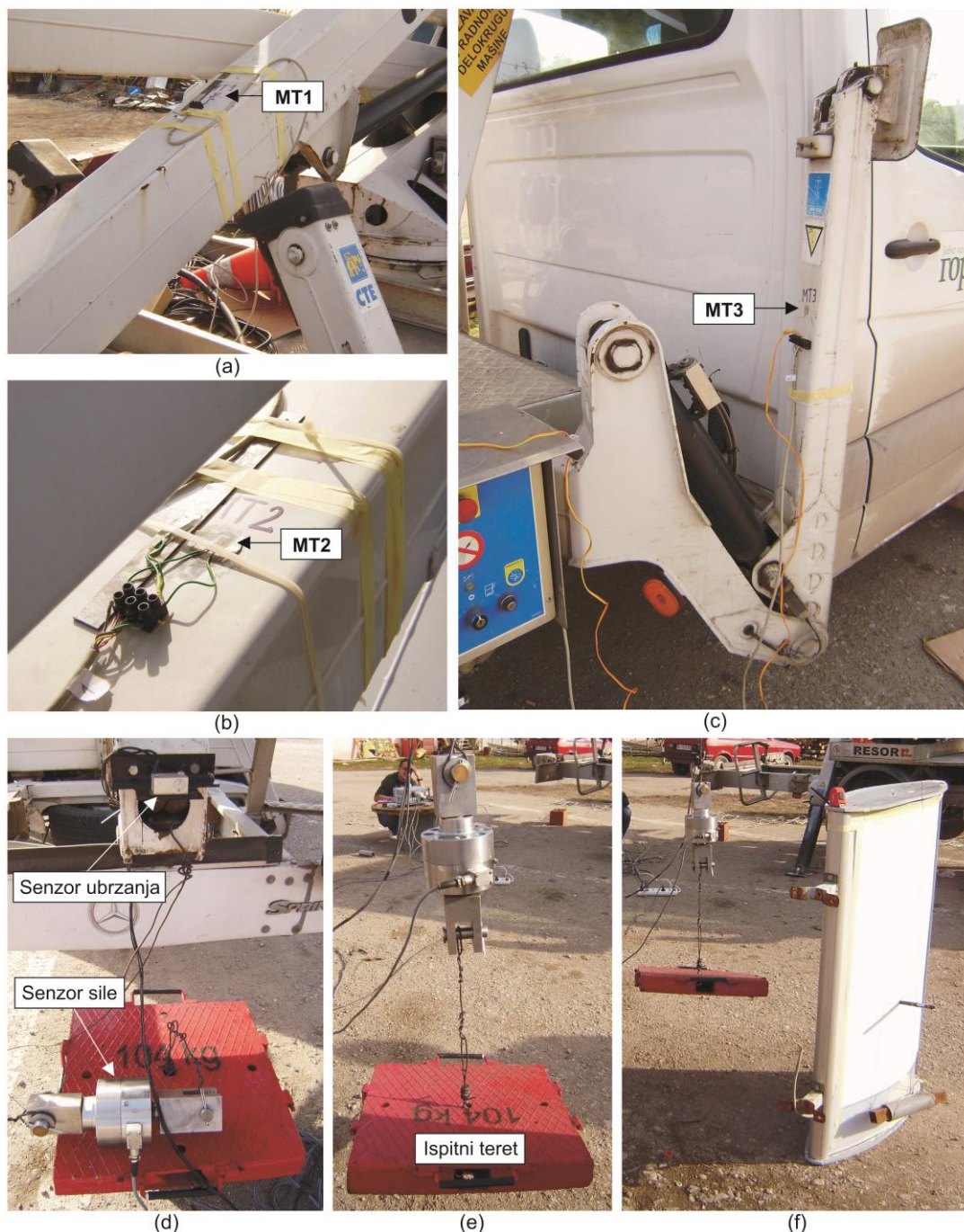
Slika 5.15 Ispitivanje podizne platforme: (a) merno mesto (merna traka) MT1 za merenje naponsko-deformacionog stanja trećeg članka zglobne strele, (b) merna traka MT2 na prvom članku zglobne strele, (c) merna traka MT3 na stabilizatoru, (d) senzori sile i ubrzanja u pripremi merenja, (e) ispitni teret i senzor sile u zauzimanju ispitnog položaja, (f) pogled na ispitni teret i davač sile (levo), i improvizovani pisac za kontrolu veličine ugiba (desno).
