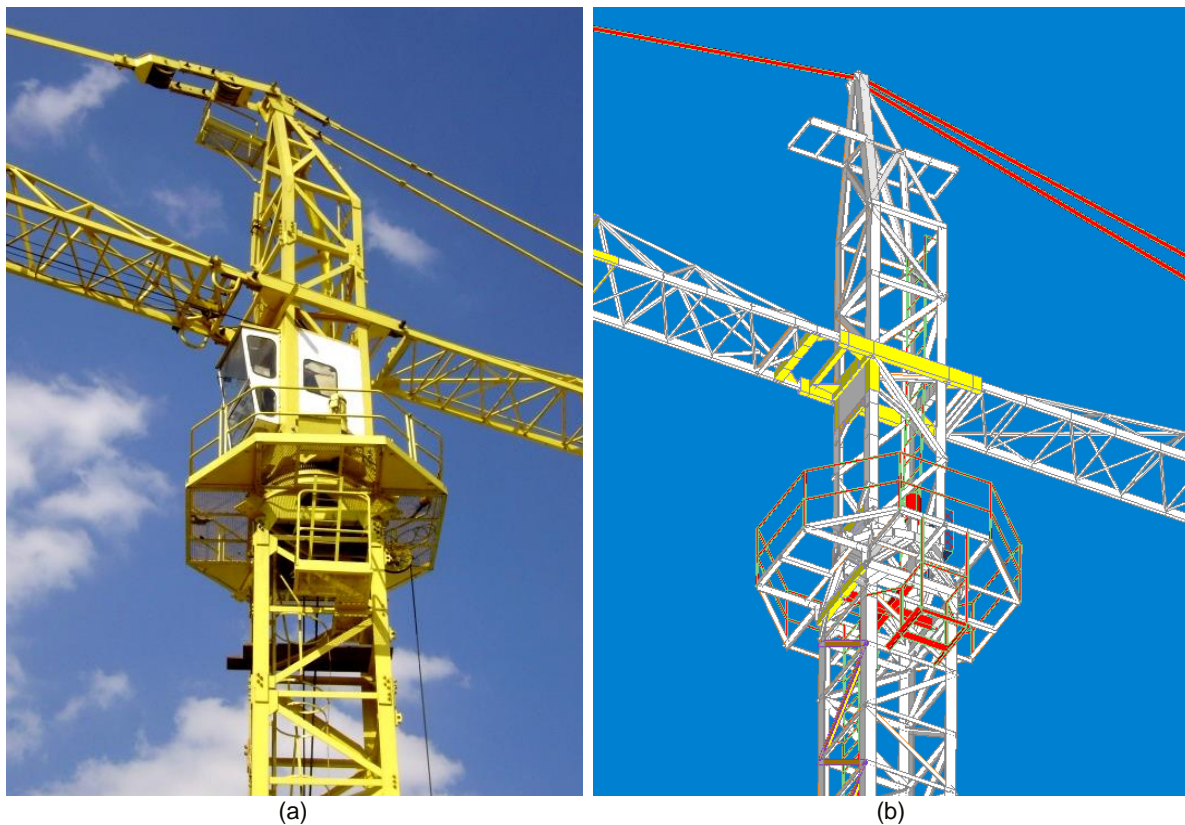
Slika 4.3 Vernost modela toranjske dizalice POTAIN-744E: (a) realna struktura, (b) FEM model razvijen za tranzijentnu analizu, [60].
