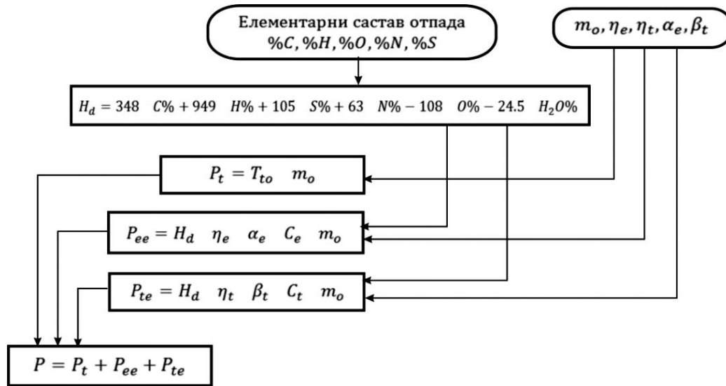
Слика 5.7 Блок дијаграм математичког модела за израчунавање прихода остварених инсинерацијом
