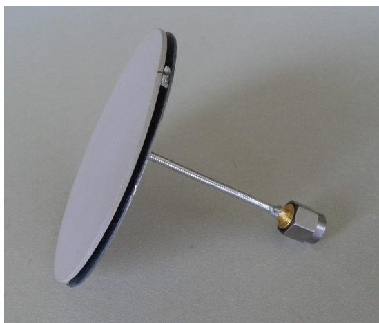
Sl. 4.23 Eksperimentalni model invertovane kružne patch antene realizovane na supstratu RO3010
