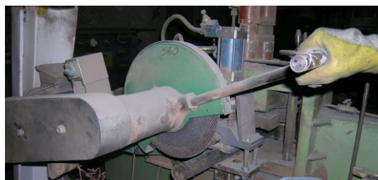
Слика 18. Сечење абразивном тестером
