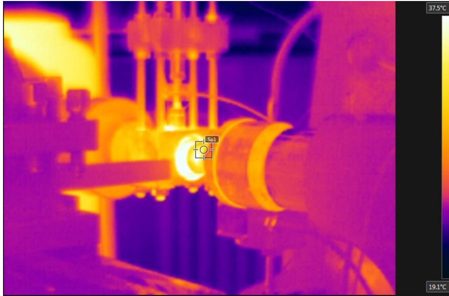
Слика 77. Температура мерена код самоподмазујућег лежаја 10_20_54_1500, T = 33.8^{\circ}\text{C}
