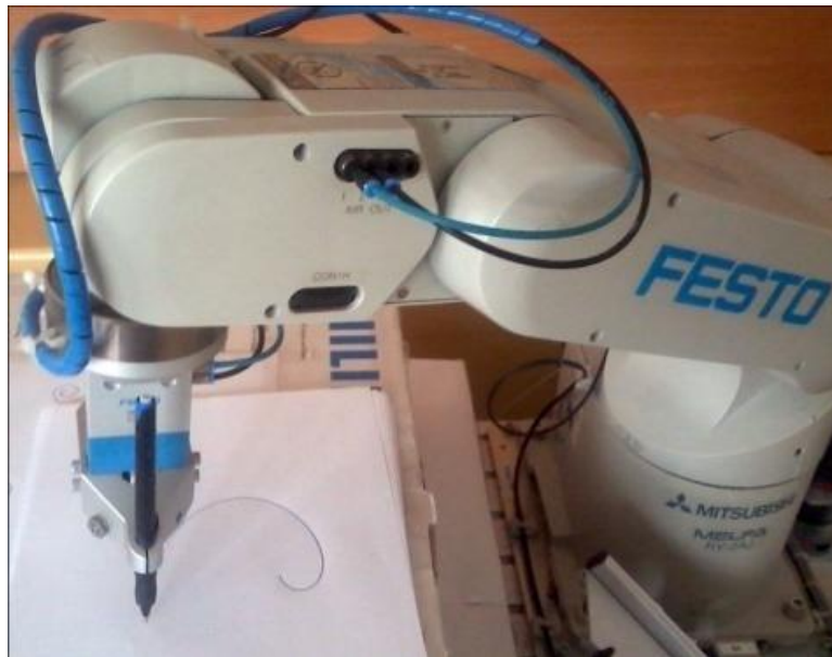
Slika p.8: Kontinualno kretanje industrijskog robota po složenoj trajektoriji
