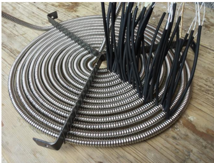
Слика 3.11 Аксијално позиционирање мерних крајева термопарова дуж истог радијалног правца спирале
