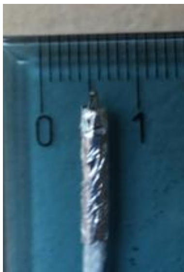
Слика 3.10 Приказ мерног краја термопара
