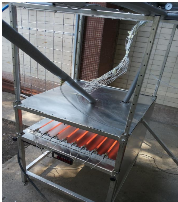
Слика 3.8 Елементи зрачећег система грејања
