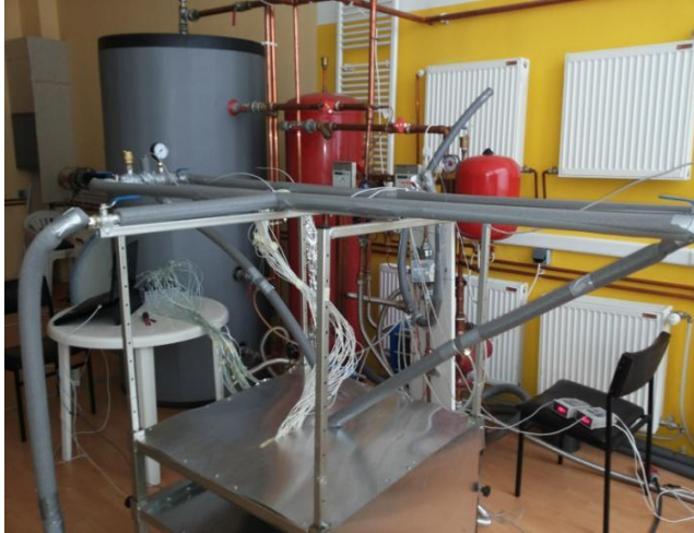
Слика 3.2 Прикључење експерименталне инсталације на затворен хидраулични систем
