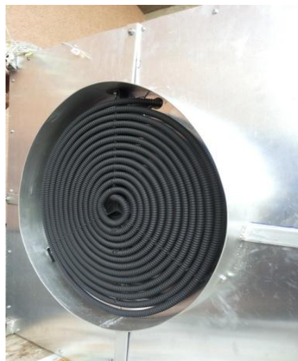
Слика 3.15 Топлотни апсорбер након наношења слоја боје високе апсорптивности
