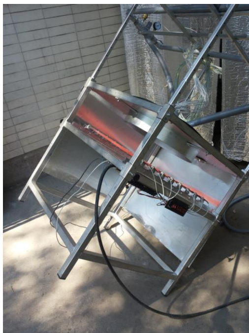
Слика 3.7 Промене угла нагиба спиралног размењивача топлоте у односу на хоризонталну раван
