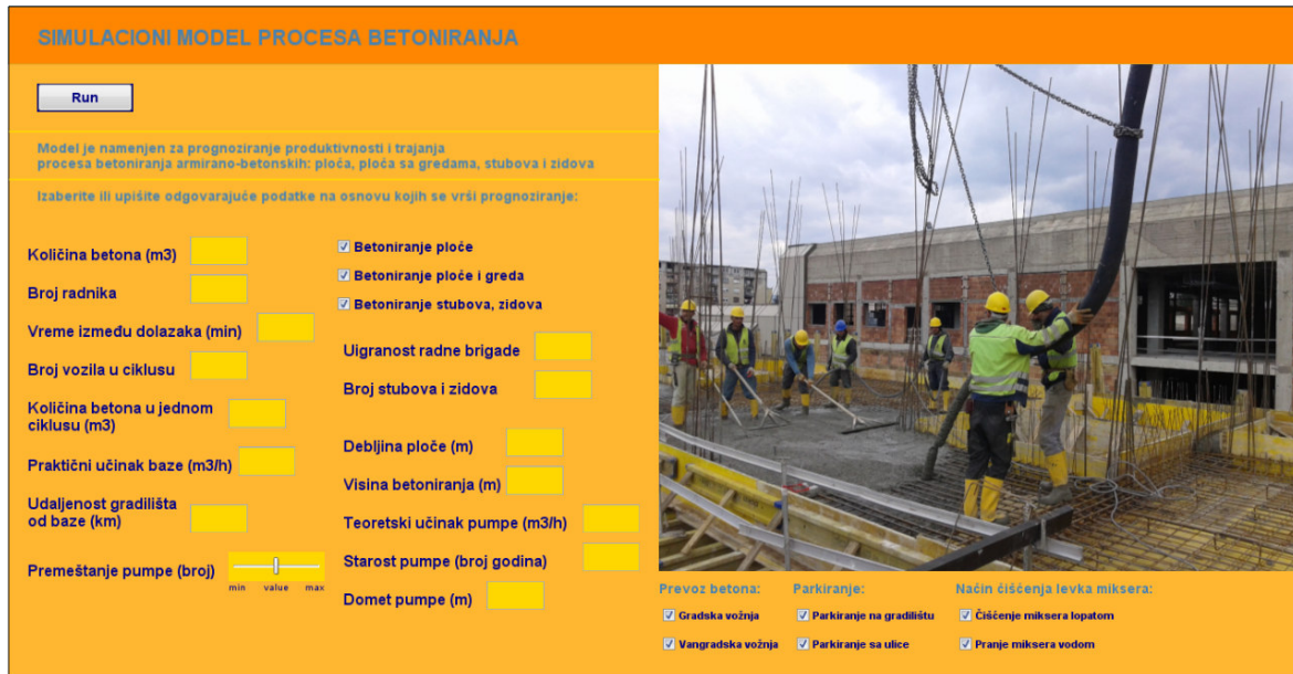
Слика 5.48 – Модел процеса бетонирања – дефинисање улазних параметара на почетку симулације
