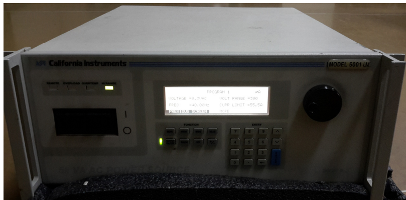
Slika 48 California Instruments, model 5001iM (tri jedinice povezane paralelno nose oznaku 15001iM)
