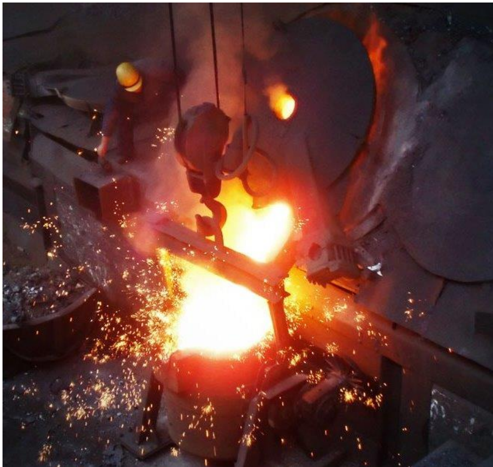
Слика 3.3. Сипање истопљеног гвожђа из пећи у лонац за транспорт
