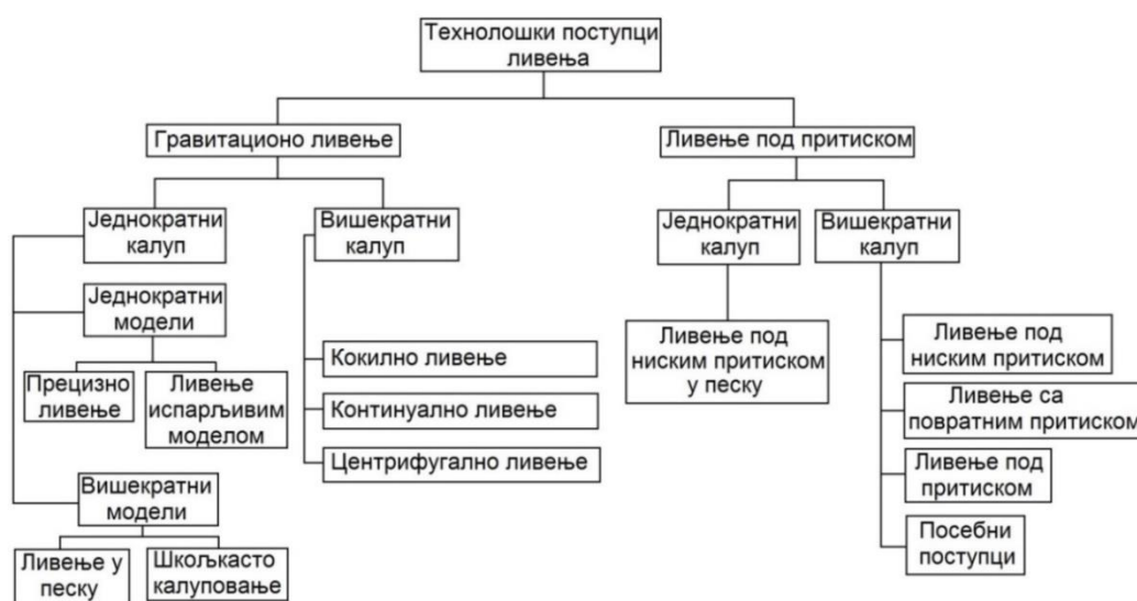
Слика 1.1. Подела технолошких поступака ливења према уливној сили и врсти калупа и модела [7]
