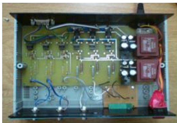
Slika 6.26. Senzorski blok za kondicioniranje ulaznih naponskih i strujnih trofaznih signala
