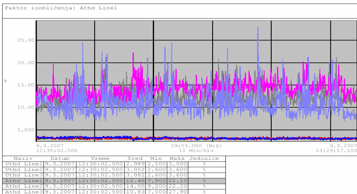
Slika 4.11. Ukupno harmonijsko izobličenje mereno uređajem C.A. 8334 u periodu od sat vremena
