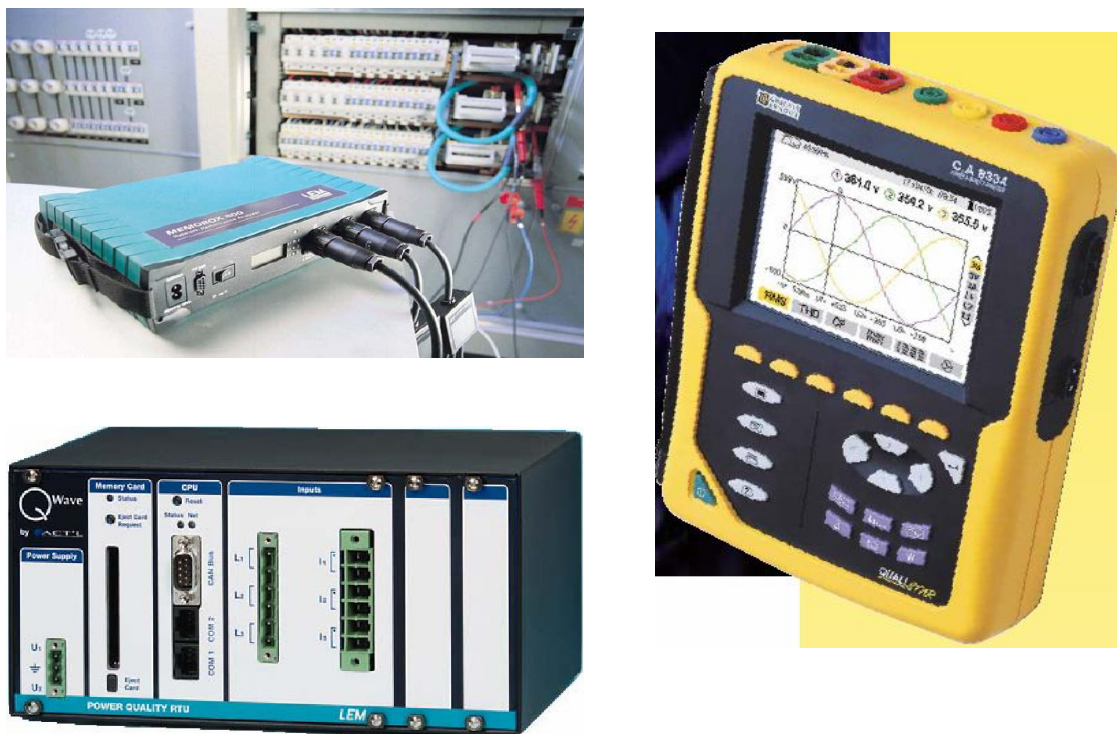
Slika 4.2. Savremeni uređaji za merenje kvaliteta električne energije tipa LEM MEMOBOX 800/808, Chauvin Arnoux CA 8332/34 (desno) i LEM-QWAVE Power (dole levo)
