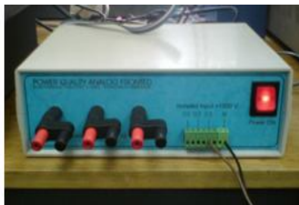
Slika 6.26. Senzorski blok za kondicioniranje ulaznih naponskih i strujnih trofaznih signala
