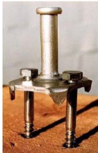
2.3.10 Posebno oblikovani spojni sistem napravljen od rebraste armature i ugrađen u drvo lepljenjem pod uglom od 45^{\circ} u odnosu na ravan spoja (Kuhlmann, Aldi 2008), levo i vertikalni moždanik posebne konstrukcije (Fragiacomo, 2007), desno.
