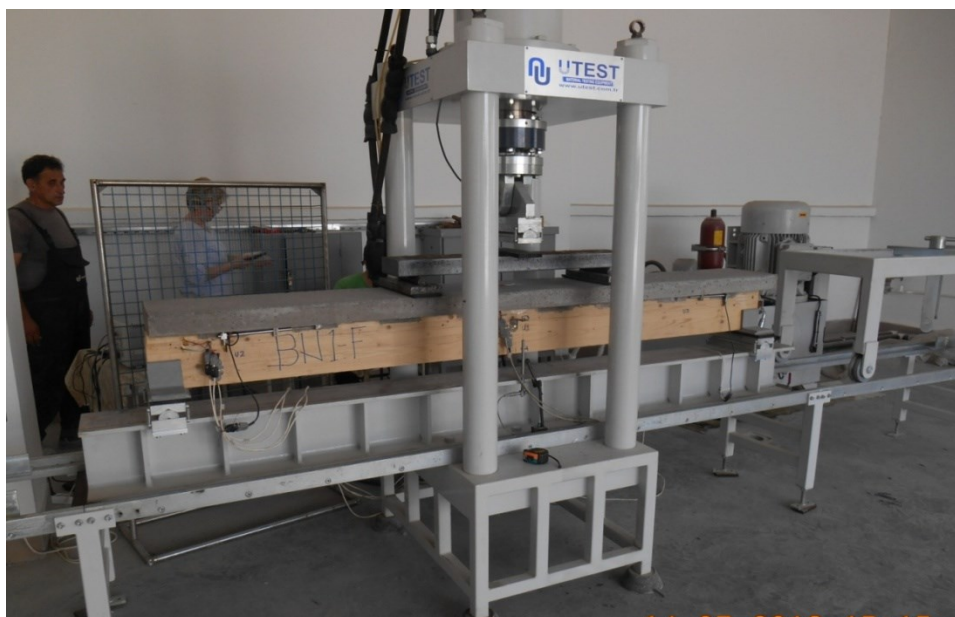
Slika 8.5.3 Eksperimentalna postavka grede BN1-F pre početka ispitivanja na visokociklično zamorno opterećenje
