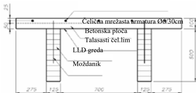
Slika 2.5.1. Poprečni presek spregnutog nosača tipa drvo-beton (Ceccotti 2006)
