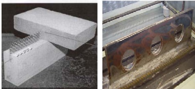
2.3.9 Čelična kontinualna mreža kao spojno sredstvo (Clouston 2005) i perforirana specijalno oblikovana čelična ploča (Miotto i Dias 2008)
