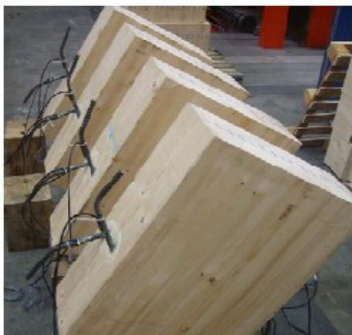
2.3.10 Posebno oblikovani spojni sistem napravljen od rebraste armature i ugrađen u drvo lepljenjem pod uglom od 45^{\circ} u odnosu na ravan spoja (Kuhlmann, Aldi 2008), levo i vertikalni moždanik posebne konstrukcije (Fragiacomo, 2007), desno.
