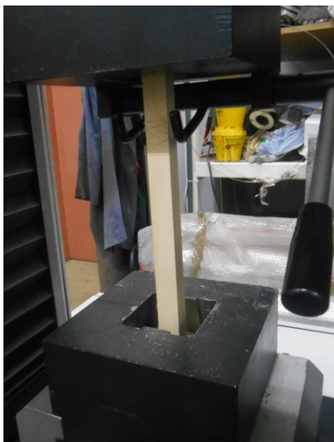
Slika 4.2.1.2 Položaj uzorka u odnosu na „čeljusti“ mašine pre početka testa
