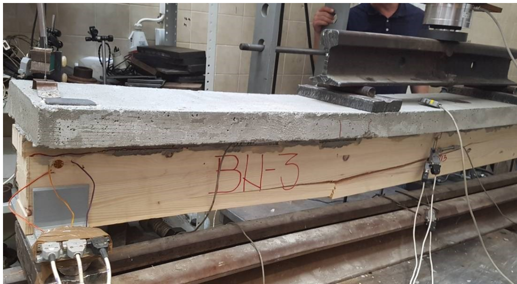
Slika 6.4.3.4 Lom grede BN-3 u zategnutoj zoni drvetu i razvoj prslina u betonu
