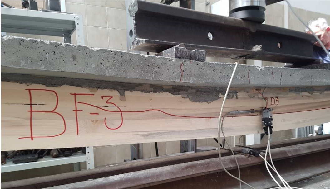
Slika 6.3.3.3 Lom grede BF-3, razvoj prslina u betonu i pukotina u drvetu
