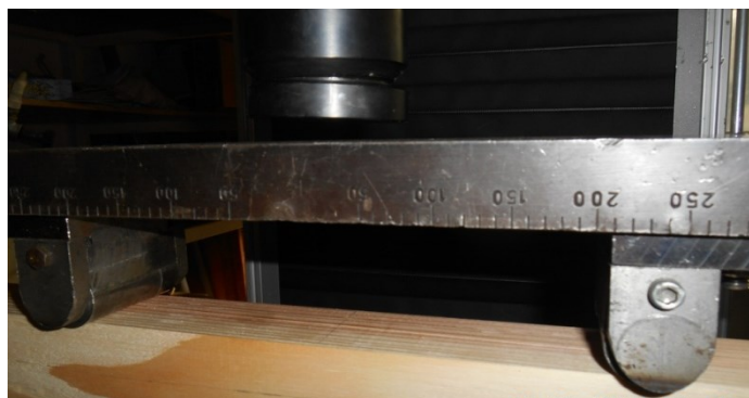
Slika 4.2.2.2 Specijalno oblikovani čelični element za prenošenje sile na uzorak
