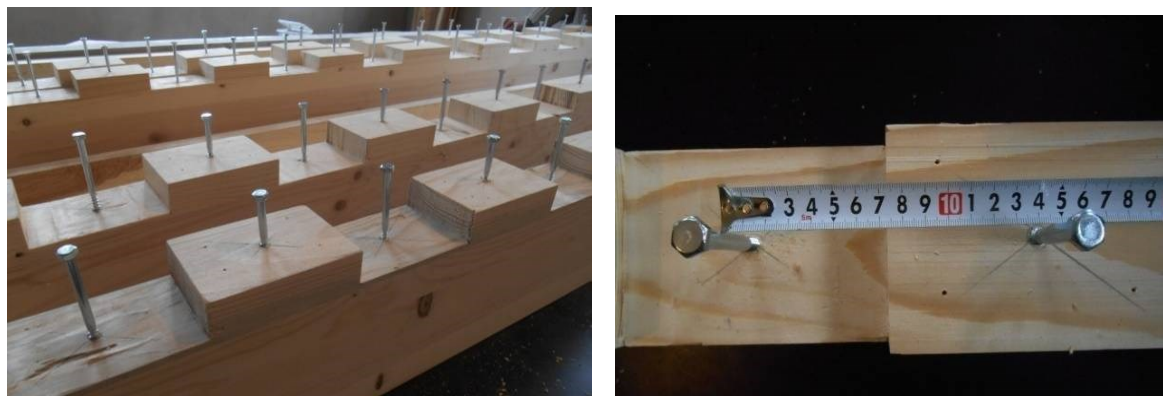
Slika 6.1.2 Sistem za sprezanje greda serije „B“: zavrtnanj + žleb ojačan zavrtnjem
