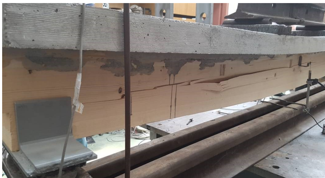
Slika 6.3.3.2 Lom grede BF-2, razvoj prslina u betonu i pukotina u drvetu
