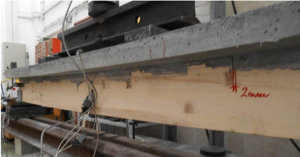
Slika 6.4.3.3 Lom grede BN-2, razvoj prslina u betonu i pukotina u drvetu
