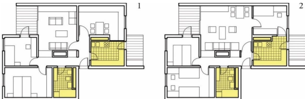
Slika 64. Instalacije pozicionirane periferno uz zid između dva stana. Naselje Krnjevo , Rijeka, 1980, Ninoslav i Vjera Kučan
