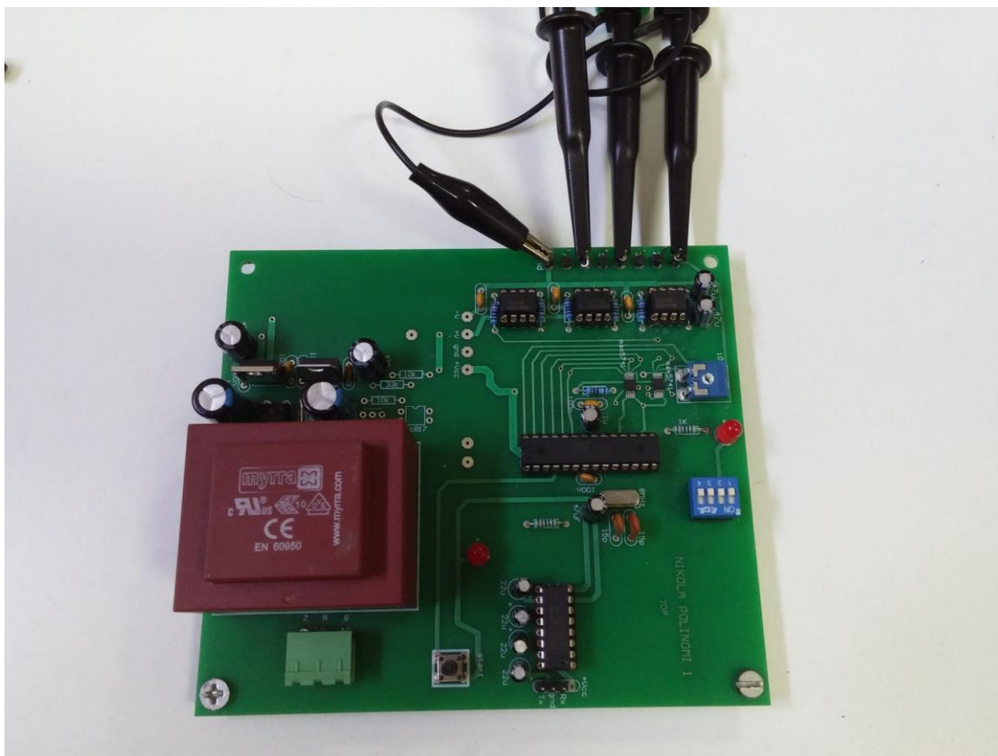
Slika 4.5 Praktična realizacija generalizovanog digitalnog ortogonalnog filtra Malmkvistovog tipa
