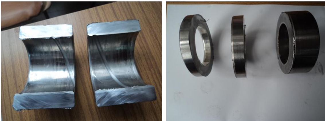
Sl. 5.39 Aksijalno rasečena uzorci posteljice ležaja (a), radijalno rasečeni uzorci (b)
