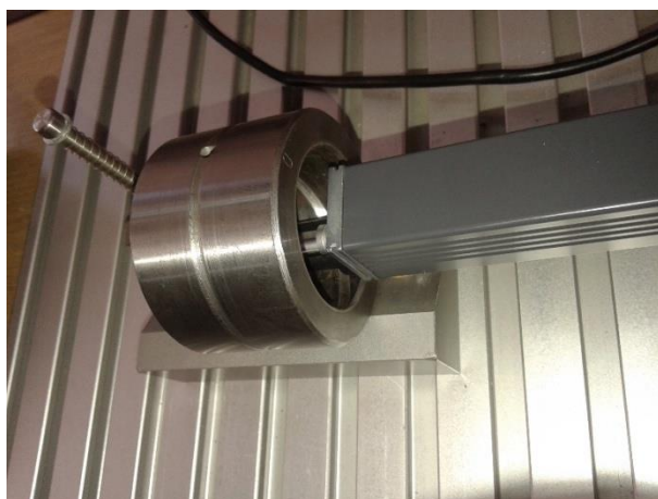
Sl. 4.7 Merenje hrapavosti jedne površine ležaja uz pomoć SURFTEST SJ-301, Mitutoyo
