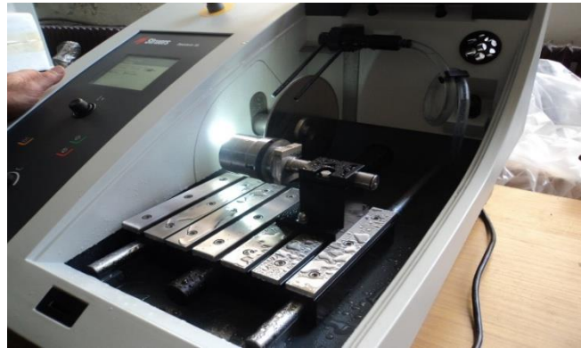
Sl. 5.38 Priprema uzoraka za ispitivanje mikrostrukture - Rasecanje posteljice ležaja
