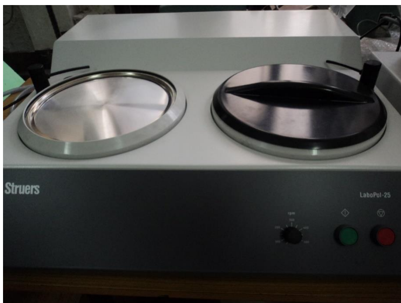
Sl. 5.40 Priprema uzoraka za ispitivanje mikrostrukture – Brušenje i poliranje uzoraka (Struers LaboPol-250 mm diskovi)
