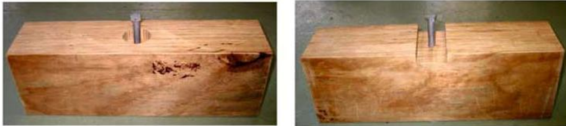
Slika 2.11 Kružni žleb (levo) i četvrtasti žleb (desno) u drvenoj gredi sa štapastim spojnim sredstvom kao ojačanjem (Deam et al. 2008)
