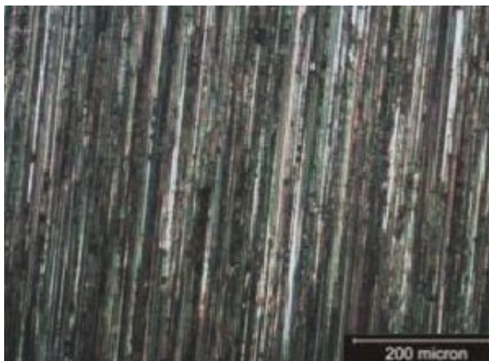
Слика 3.9 Узорак број 76, завршна обрада подлоге брушење-режим A_2
