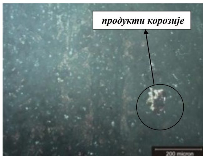
б) Изглед превлака после 320 сати стајања у раствору NaCl
