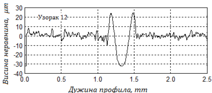
Слика 5.31 Истискивање материјала превлаке цинка
