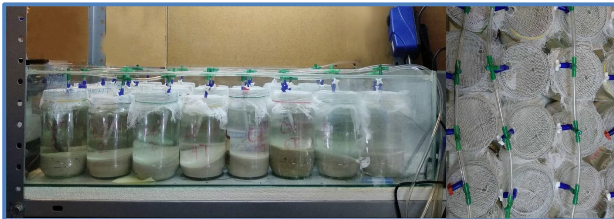
Slika 14 - Izgled eksperimentalne postavke u laboratoriji na PMFu u Nišu, za bioesej sa hironomidama, po OECD smernicama za Test 218.
