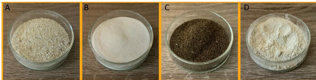
Slika 17 – Set eksperimenata za testiranje i odabir adekvatne podloge – testirane komponente podloge A – krupan kvarcni pesak (grubo granulisan), B – Sitan kvarcni pesak (fino granulisan), C – treset (prosejan), D – kaolinska glina.
