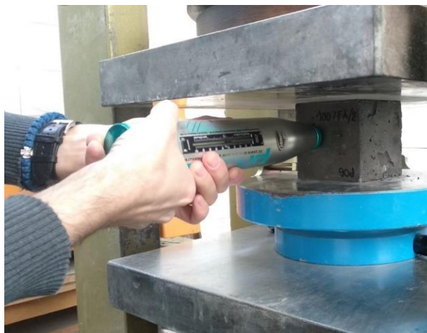
Слика 7.57 Испитивање одскочног броја склерометром на узорку геополимерног бетона
