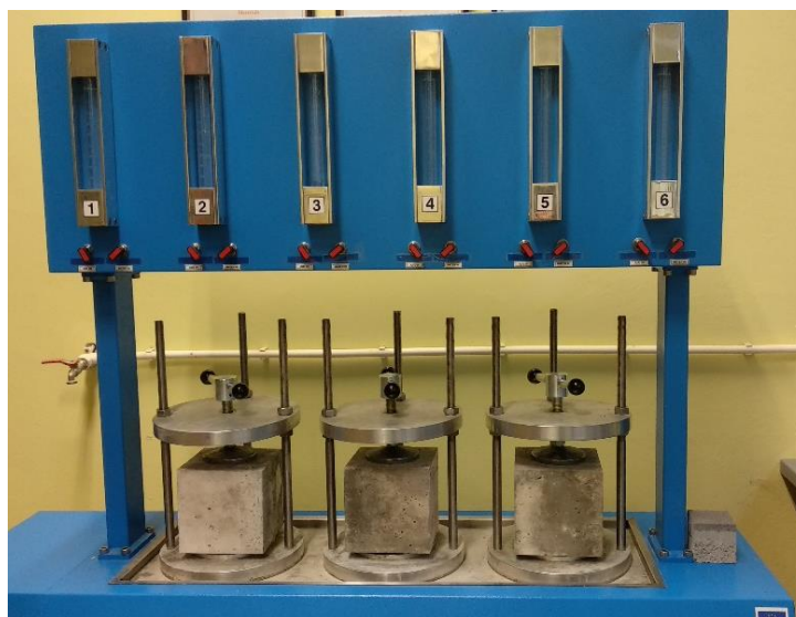
Слика 7.68 Испитивање дубине пенетрације воде под притиском
