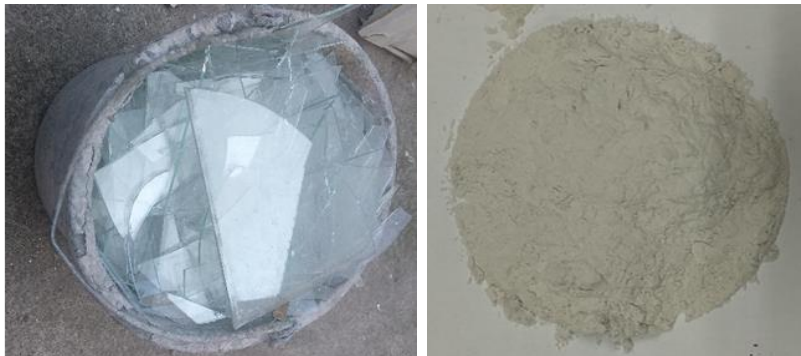
Слика 7.7 Изглед отпадног стакла: узоркован материјал (лево), материјал припремљене за справљање малтера и бетон (десно)
