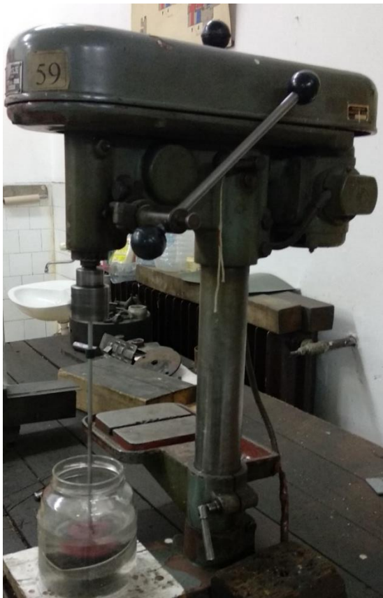
Слика 7.34 Апаратура коришћена за добијања елуата
