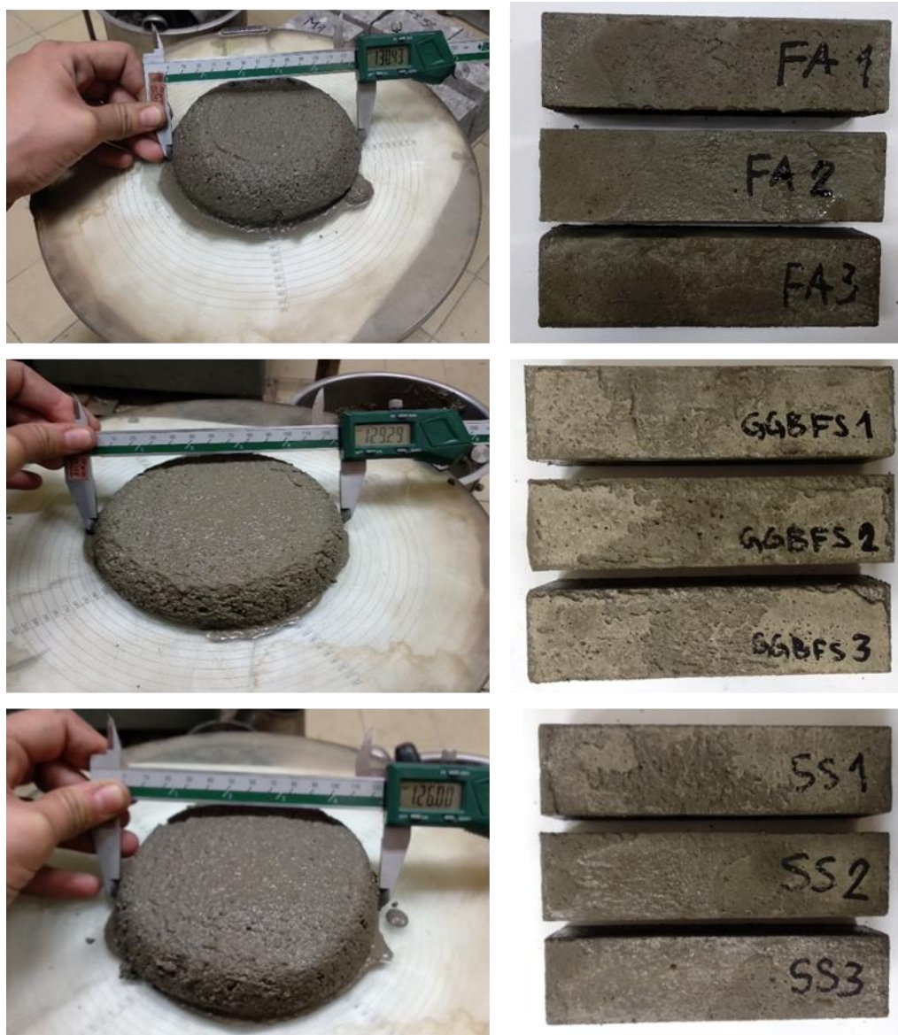
Слика 7.9-1 Испитивање индекса активности: мерење распростирања на потресном столу (лево), изглед узорка очврслог малтера справљеног додатком (десно): FA - електрофилтерски пепео, GGBFS - гранулисана згура из високе пећи и SS - конверторска згура
