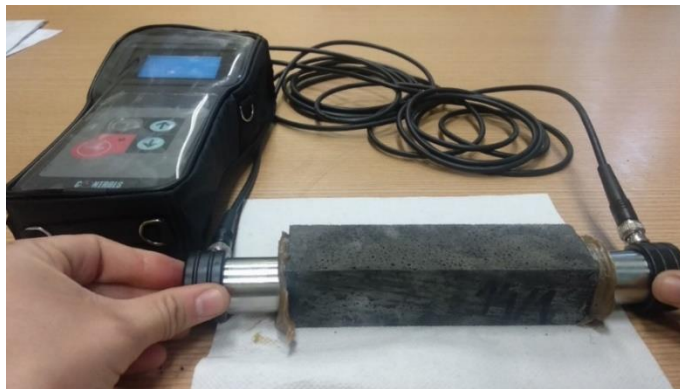
Слика 7.26 Испитивање брзине проласка ултразвучног импулса кроз малтерску призму
