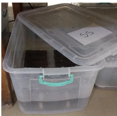
Слика 7.31 Узорци потопљени у 5 % раствор \text{Na}_2\text{SO}_4
