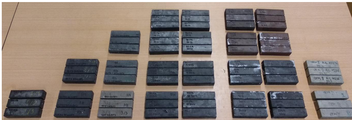
Слика 7.32 Изглед узорка након 180 дана од потапања у 5 % раствор \text{Na}_2\text{SO}_4
