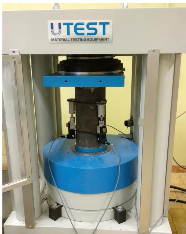
Слика 7.63 Одређивање модула еластичности при притиску – извод из софтвера
