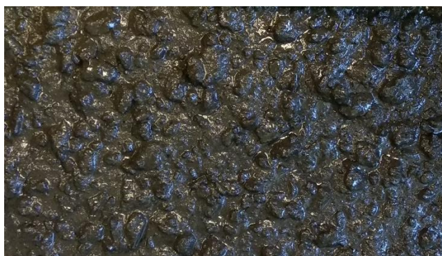
Слика 7.38 Изглед самоуграђујуће геополимерне бетонске мешавине ознаке „FA“ одмах након справљања
