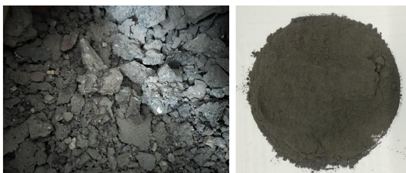
Слика 7.4 Конверска (челичанска) згура: узоркован материјал (лево), материјал припремљене за справљање малтера и бетон (десно)
