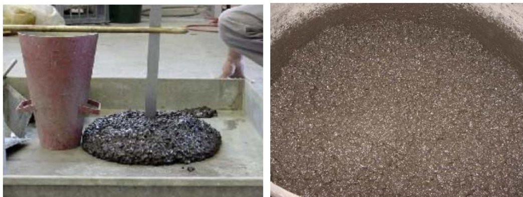
Слика 4.2 Испитивање слегања геополимерног бетона (лево) и изглед бетона након справљања (десно) [55]
