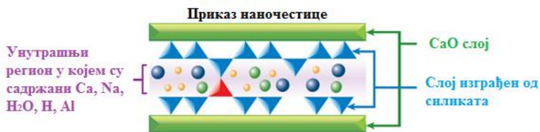
Слика 3.5 Структура наночестице C-S-H гела: плави троугао представља Si, црвени троугао представља Al, зелени правоугаоници представљају слојеве CaO а кружићи представљају међузависне слојеве [30]
