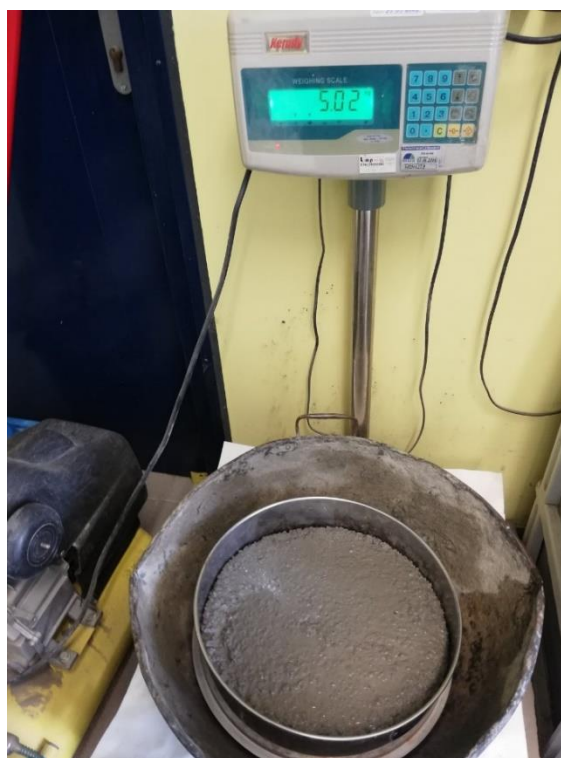
Слика 7.43 Испитивање отпорности на сагрегацију
