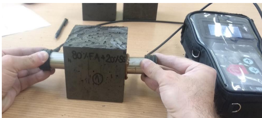
Слика 7.59 Испитивање брзине проласка ултразвучног импулса кроз бетон
