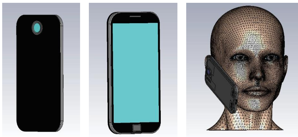
Slika 4.3.1 - Izgled 3D numeričkog modela mobilnog telefona
