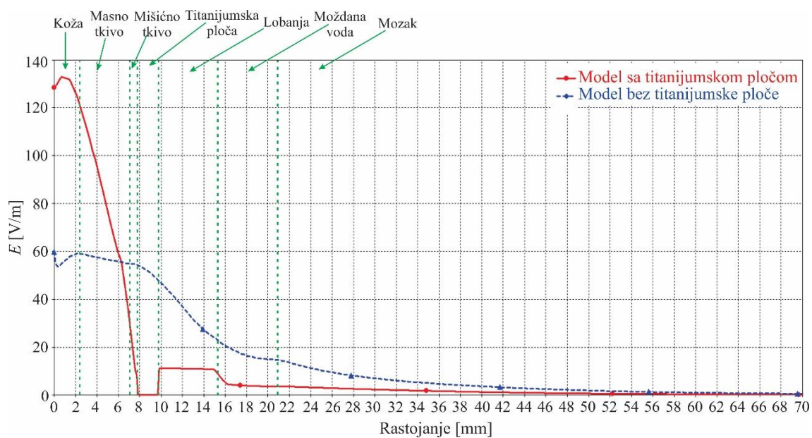
Slika 5.1.17 - Promena intenziteta električnog polja E [V/m] duž pravca C_2 .
