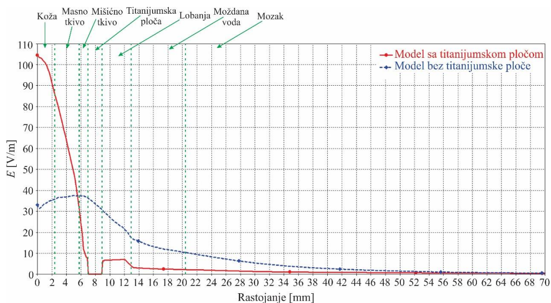
Slika 5.1.16 - Promena intenziteta električnog polja E [V/m] duž pravca C_1 .
