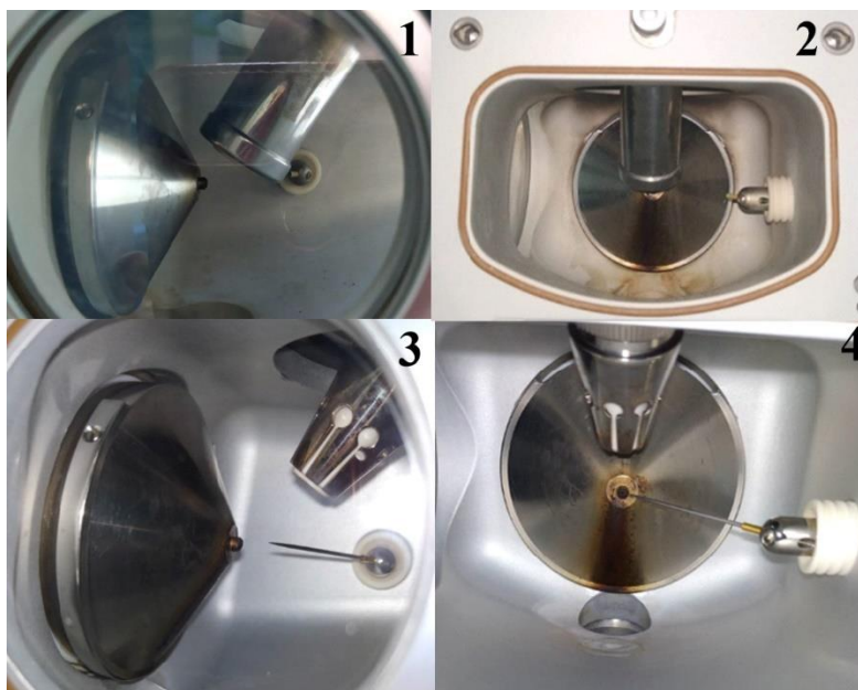
Slika 2.3-5 Konfiguracija ESI probe (1,2) i APCI probe sa korona iglom (3,4) u okviru jonskog izvora
