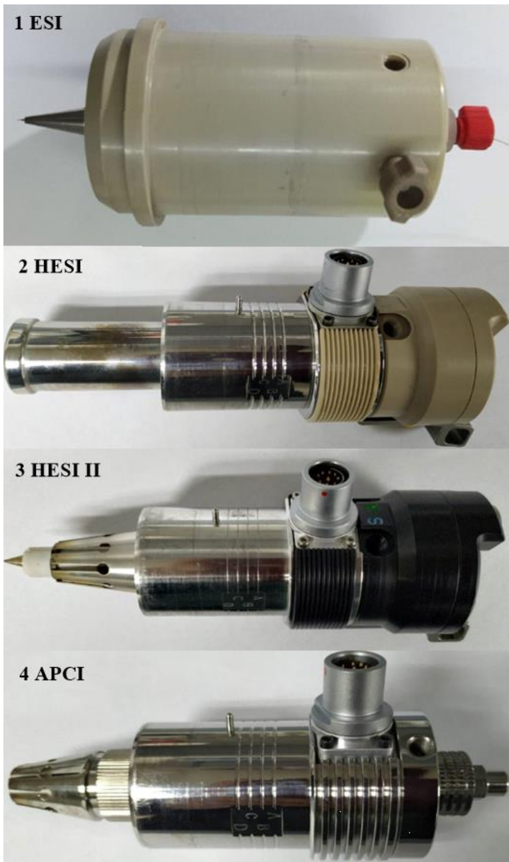
Slika 3.2-3 Tipovi varijabilnih delova API jonskih izvora (varijante ESI probe (1-3) i APCI proba (4))
