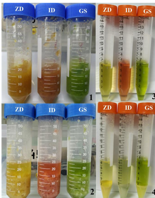
Slika 4.3-39 QuEChERS procedura (EN 15662) kroz korake: kora nakon ekstrakcije acetonitrilom (1); kora nakon sukcesivnog dodatka citratnih soli i mućkanja (2); ekstrakti kore nakon centrifugiranja (ekstrakt spreman za dSPE ) (3); ekstrakti kore nakon koraka dSPE sa PSA (4); ZD – Zlatni Delišes; ID – Ajdared; GS – Greni Smit
