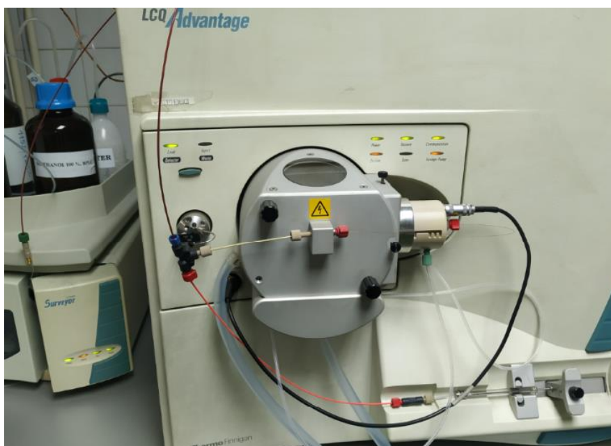
Slika 3.4-3 Sistem za uvođenje uzorka u maseni spektrometar direct injection metodom
