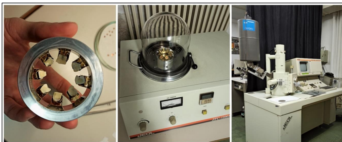
Slika 30. Naparavanje uzoraka zlatom u vakuum aparatu i analiza skening elektronskim mikroskopom.
