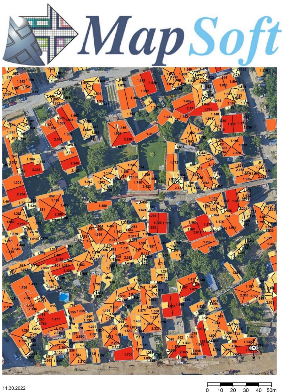
Slika 139. Mikrolokacija solarnog potencijala krovova ČJ5 (GisVranje)
