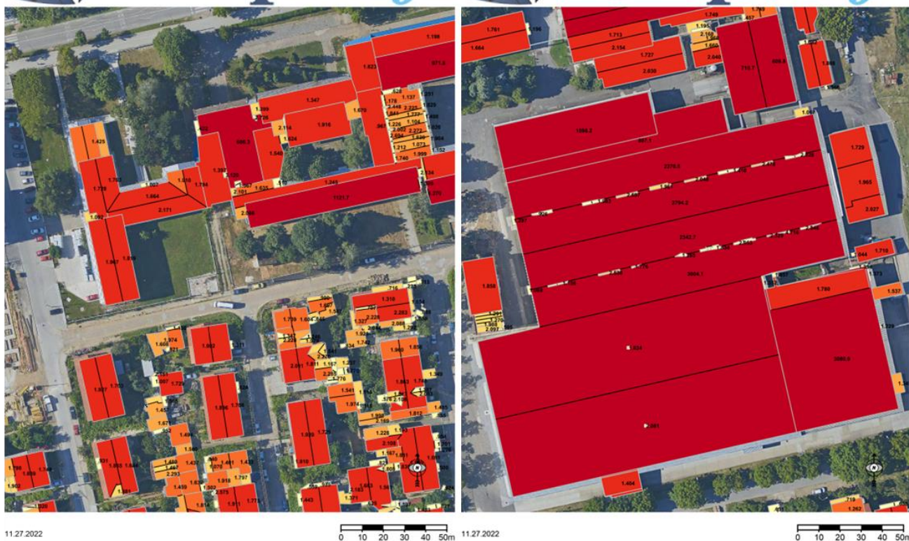
Slika 127. Mikrolokacija solarnog potencijala krovova ĆJ2: a) krovovi javnih zgrada i stanovanja; b) krovovi poslovne proizvodnje (GISVranje)
