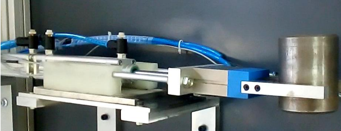
Слика 6.10 Извлачење клипњаче пнеуматског цилиндра Е – премјештање предмета рада ка врху магацина
