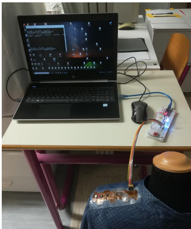
Slika 115. Prenos podataka kod prvog prototipa pametne majice
