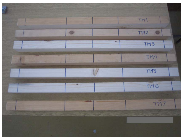
Slika 4.1.2.1 Uzorci za određivanje modula elastičnosti pri savijanju
