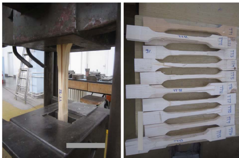
Slika 4.1.1.3 Lom uzoraka pri ispitivanju čvrstoće na zatezanje paralelno vlaknima
