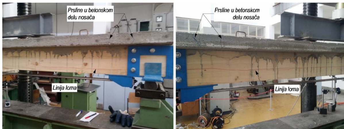
Slika 5.4.4.3 Lom grede PSG3
