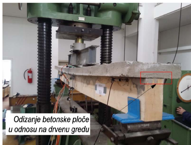
Slika 5.4.2.6 Odizanje betonske ploče
