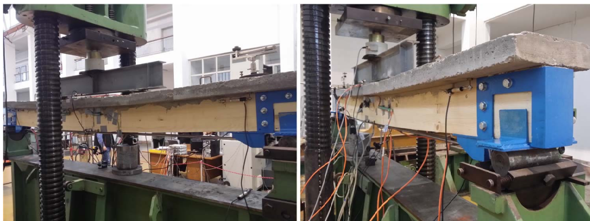
Slika 5.4.4.1 Izgled deformisanog spregnuto-prednapregnutog nosača
