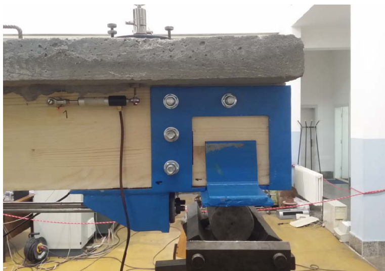
Slika 5.4.4.7 Položaj uređaja za merenje relativnog pomeranja kod prednapregnutih nosača
