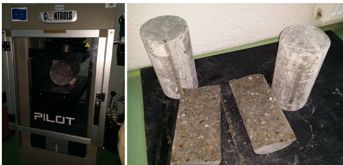
Slika 4.3.2.1 Ispitivanje čvrstoće na zatezanje cepanjem (uzorci pre i posle ispitivanja)
