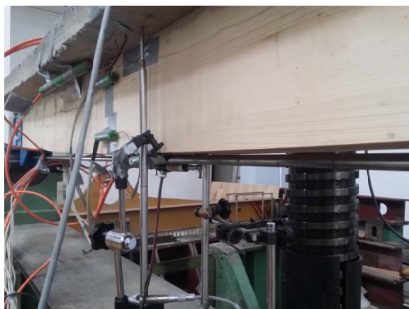
Slika 5.4.4.2 Kontakt donje ivice rebra sa čeličnim zategama
