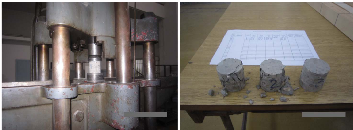
Slika 4.3.1.2 Ispitivanje čvrstoće na pritisak kernova od betona (uzorak u mašini za ispitivanje kao i izgled uzoraka nakon ispitivanja)
