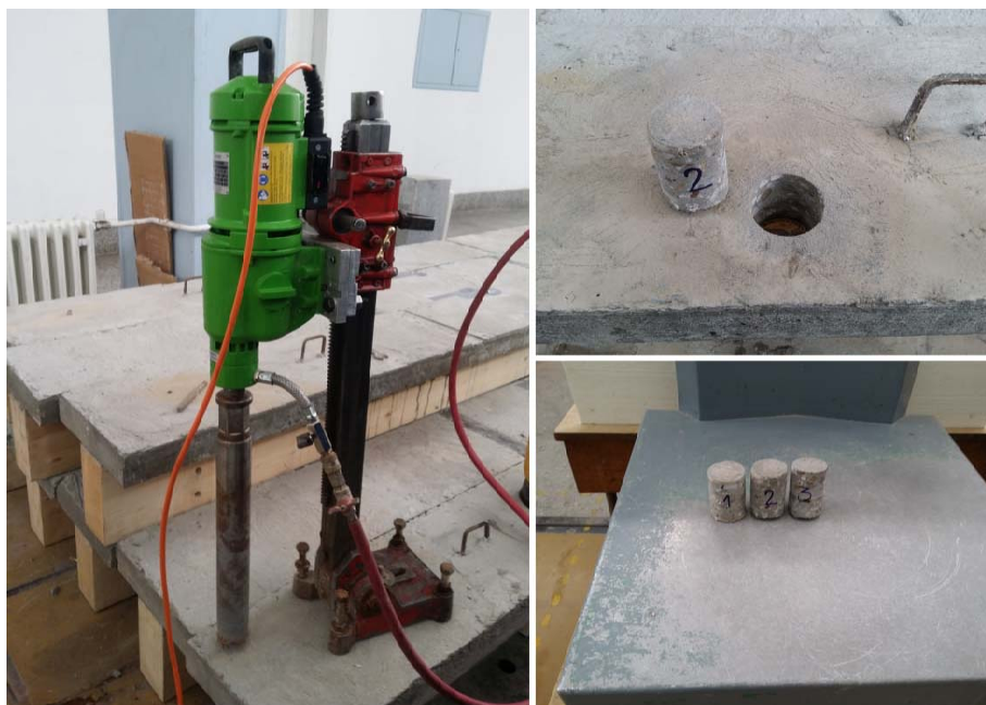
Slika 4.3.1.1 Uzimanje uzoraka iz ispitanih greda kako bi se odredila čvrstoća betona na pritisak
