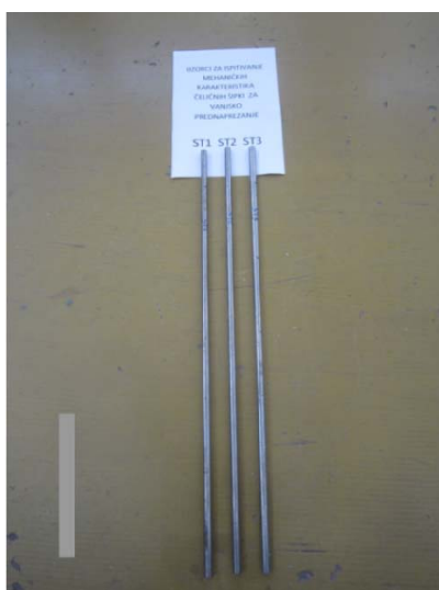
Slika 4.2.1.1 Uzorci korišteni za određivanje čvrstoće na zatezanje i modula elastičnosti
