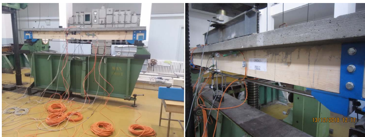
Slika 5.4.1.3 Postavka ispitivanja spregnuto-prednapregnutih nosača
