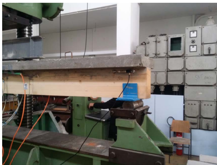
Slika 5.4.2.5 Položaj uređaja za merenje relativnog klizanja između drvenog i betonskog dela nosača
