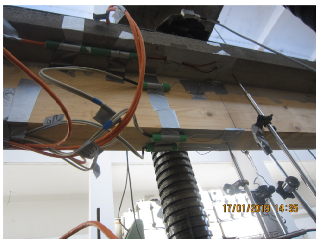
Slika 5.4.3.1 Označavanje i raspored mernih traka na spregnutom nosaču
