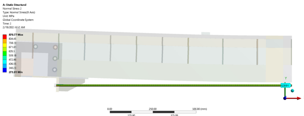
Slika 6.2.3.14 Ukupni normalni napon u X pravcu u šipci za prednaprezanje na kraju drugog koraka [MPa]
