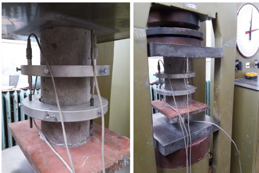
Slika 4.3.3.1 Postavka eksperimenta za određivanje modula elastičnosti betonskih uzoraka
