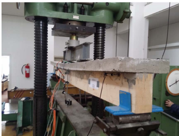
Slika 5.4.2.1 Izgled deformisanog nosača tokom ispitivanja
