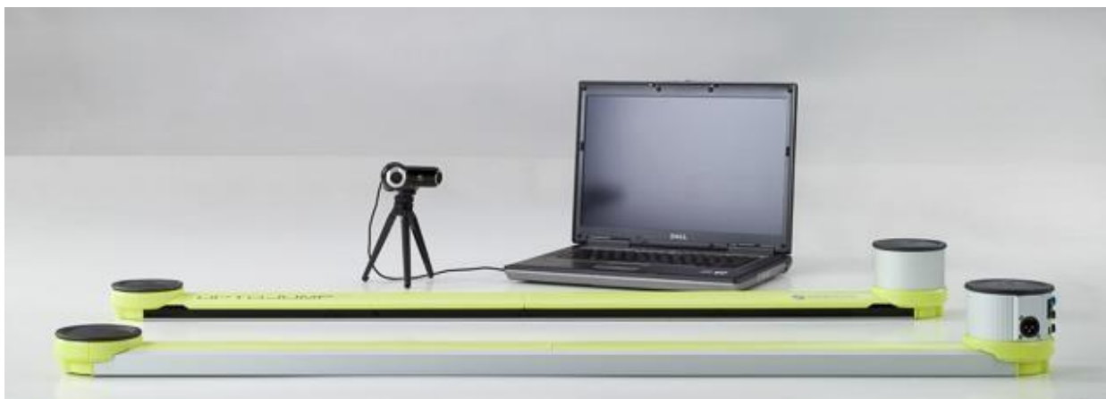
Слика 13. Ортојумп – оптички систем за мерење.
