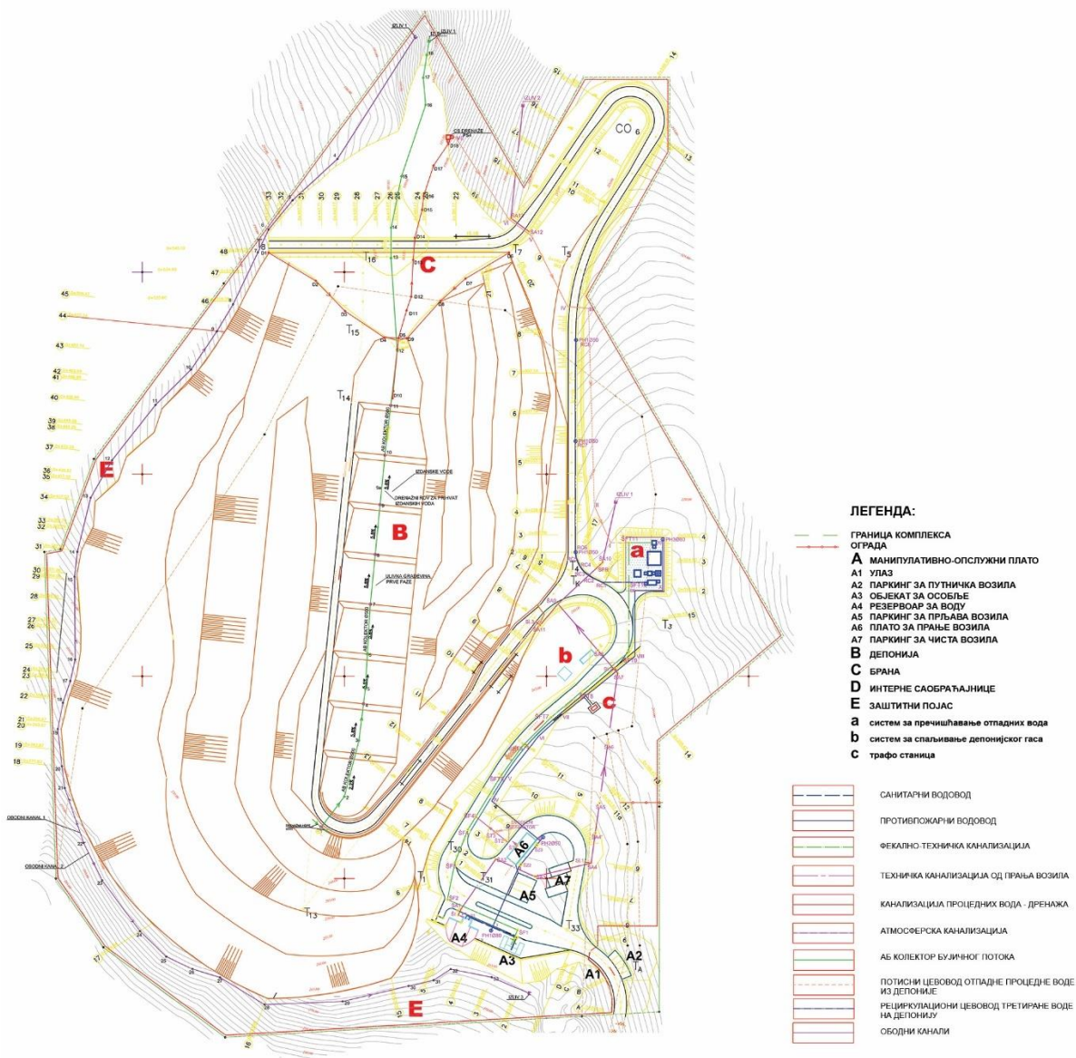
Слика 7.9 Ситуација одвођења вода са комплекса депоније „Гигох“ [102]
