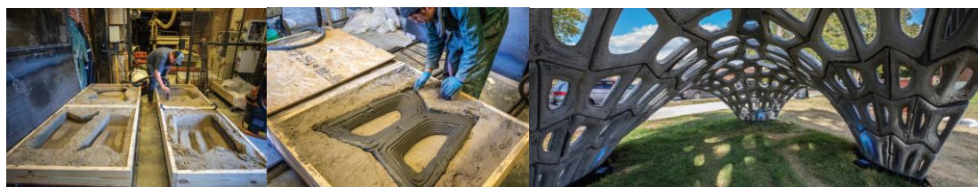
Слика 2-3. Приказ префабрикације бетонских модула 3Д штампом и калупом од песка као и коначног демонстратора ДЕ:Стрес (енгл. DE:Stress ) (Battaglia et al., 2020)
