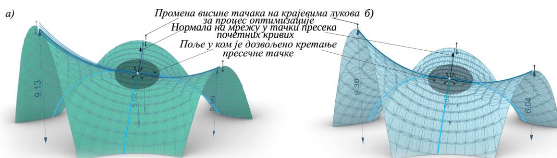
Слика 4-16. Приказ два решења из процеса оптимизације Галапагоса са улазним параметром форме
