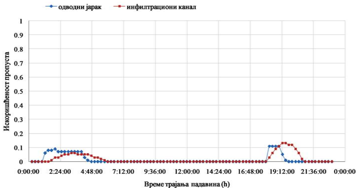
Слика 6.28 Искоришћеност капацитета цевастог пропуста при одводњавању одводним јарковима (Модел 4.1) и при одводњавању инфилтрационим каналима (Модел 4.2)
