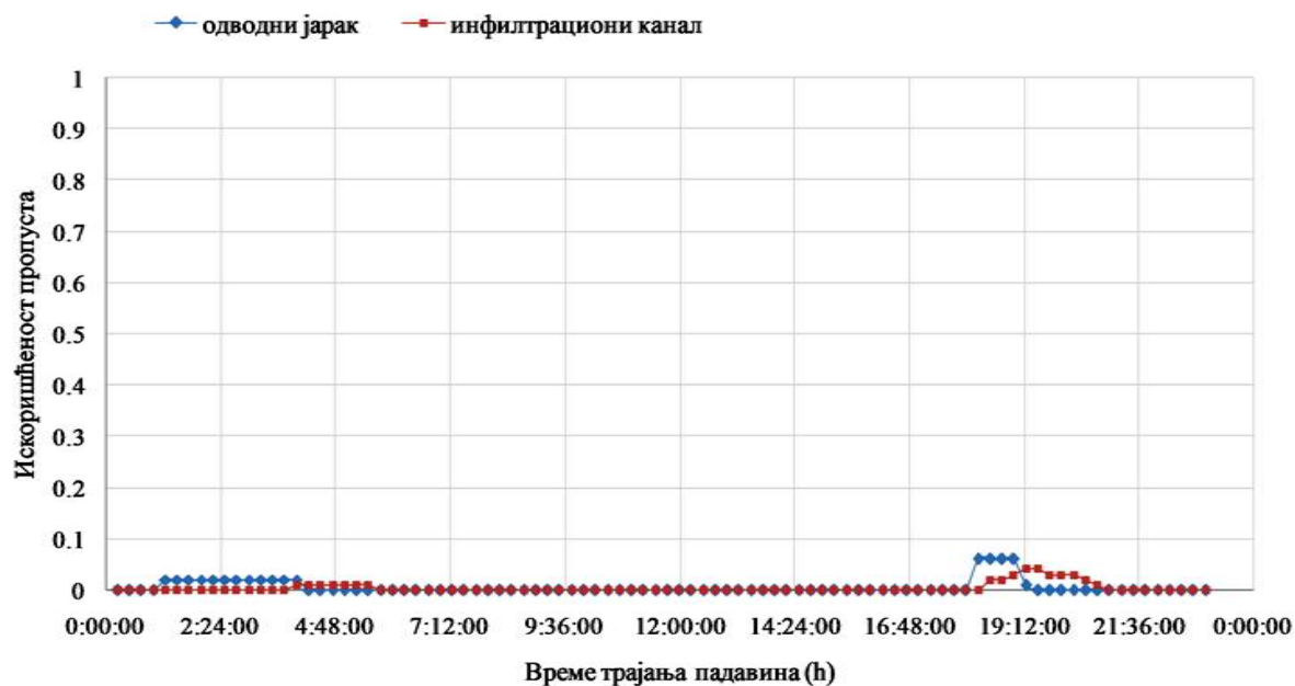
Слика 6.7 Искоришћеност капацитета цевастог пропуста при одводњавању одводним јарковима (Модел 1.1) и при одводњавању инфилтрационим каналима (Модел 1.2)
