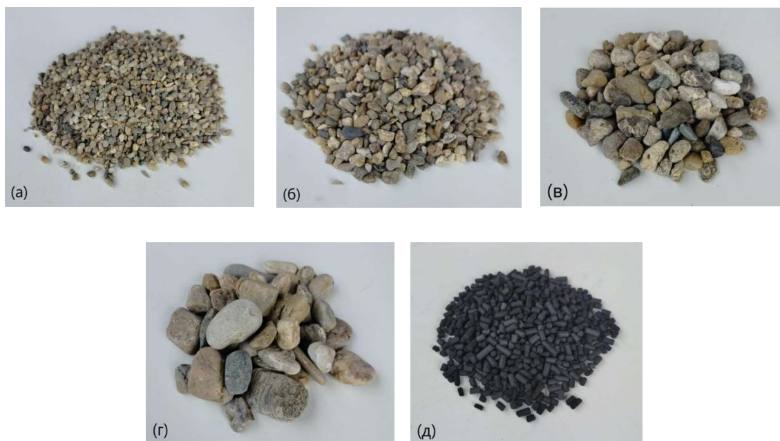
Слика 5.12 Изглед материјала коришћених за справљање филтер слојева: (а) речни агрегат фракције 2–4 mm, (б) речни агрегат фракције 4–8 mm, (в) речни агрегат фракције 8–16 mm, (г) речни агрегат фракције 16–31,5 mm, (д) активни угљ
