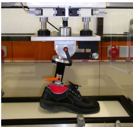
Слика 2.20 Опрема за тестирање отпорности на клизање обуће
