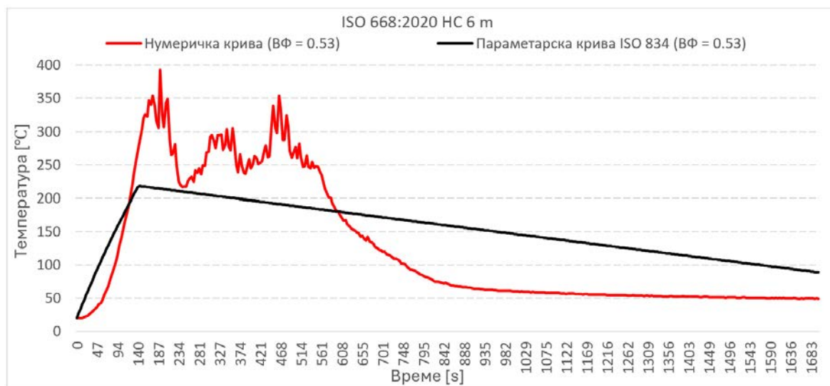
Слика 7.7 Нумеричка пожарна крива и параметарска пожарна крива, пожар контролисан вентилационим фактором, V\Phi = 0.53
