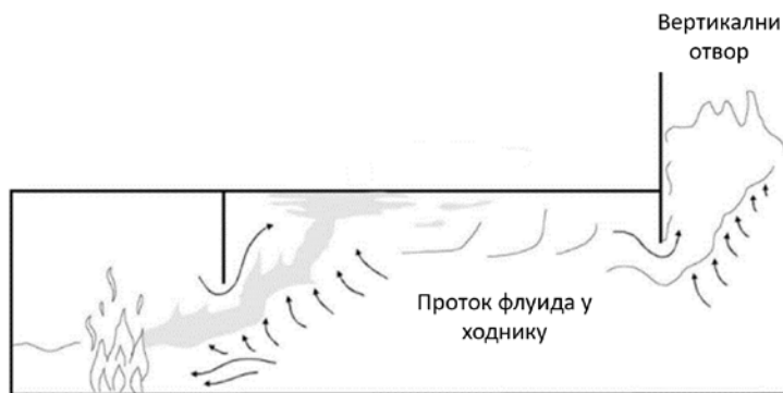
Слика 4.3 Проток флуида дуж ходника и вертикалних отвора
