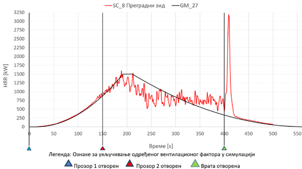
Слика 6.9 Polyethylene_GM 27 - HRR kriva и HRR kriva ISO 668:2020 HC 9 m, сценарио SC_8 са преградним зидом, у условима отварања прозора на А страни модела у 0 s, отварања прозора на Д страни модела у 150 s и отварања врата на Б страни модела у 400 s.
