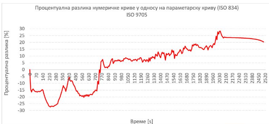
Слика 7.6 Процентуална разлика нумеричке пожарне криве у односу на параметарску пожарну криву (ISO 834), за средњу вредност, ВФ = 0.1 - 2.26
