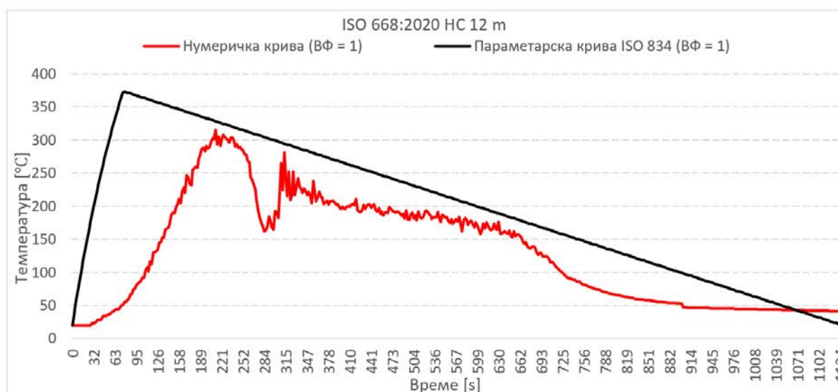
Слика 7.21 Нумеричка пожарна крива и параметарска пожарна крива, пожар контролисан вентилационим фактором ВФ = 1
