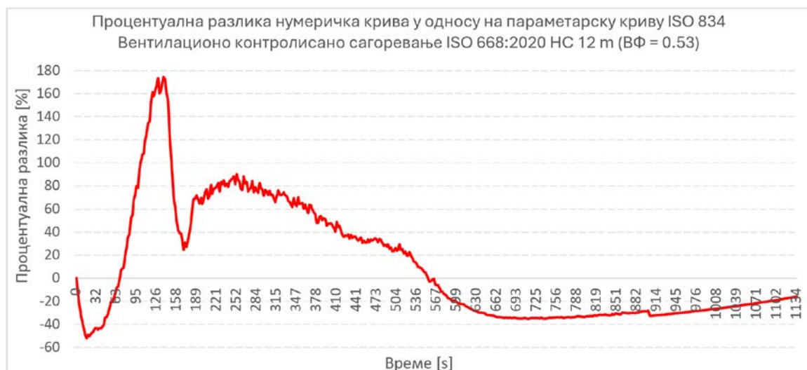
Слика 7.20 Процентуална разлика нумеричке пожарне криве у односу на параметарску пожарну криву (ИСО 834), пожар контролисан вентилационим фактором, ВФ = 0.53
