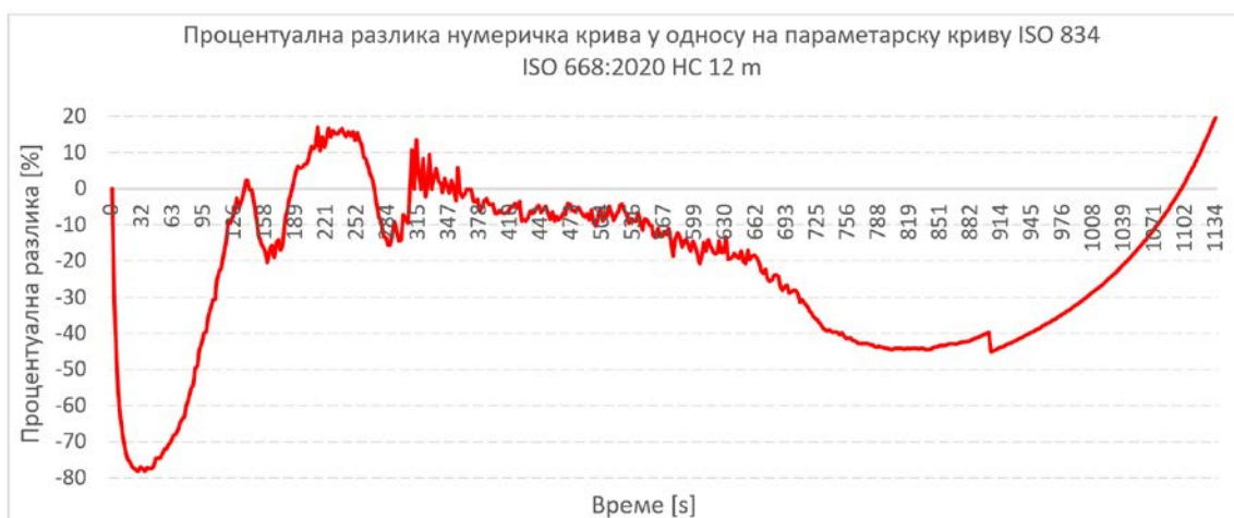
Слика 7.24 Процентуална разлика нумеричке пожарне криве у односу на параметарску пожарну криву, за средњу вредност VФ = 0.53 - 1
