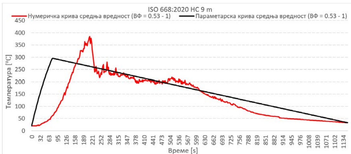
Слика 7.17 Средња вредност нумеричке пожарне криве и параметарске пожарне криве, пожара контролисан вентилационим фактором, V\Phi = 0.53 - 1
