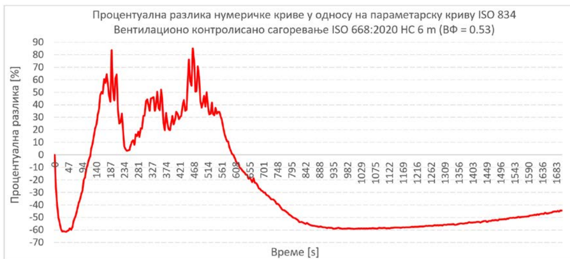
Слика 7.8 Процентуална разлика нумеричке пожарне криве у односу на параметарску пожарну криву (ISO 834), пожар контролисан вентилационим фактором, VФ = 0.53
