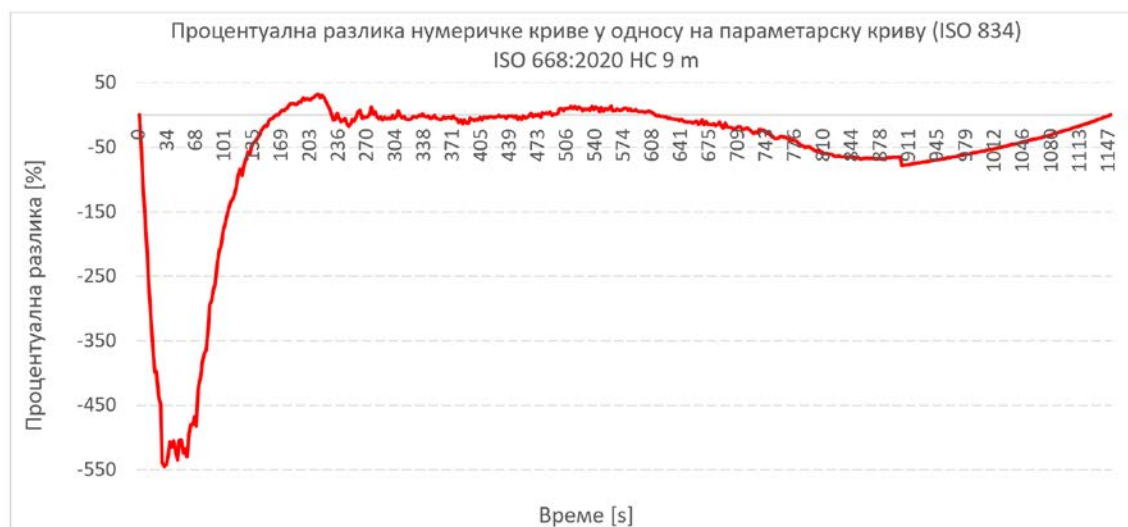
Слика 7.18 Процентуална разлика нумеричке пожарне криве у односу на параметарску пожарну криву (ISO 834), за средњу вредност, V\Phi = 0.53 - 1
