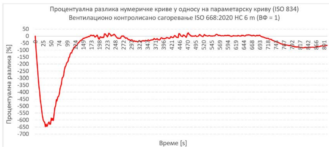
Слика 7.10 Процентуална разлика нумеричке пожарне криве у односу на параметарску пожарну криву (ISO 834), пожар контролисан вентилационим фактором ВФ = 1
