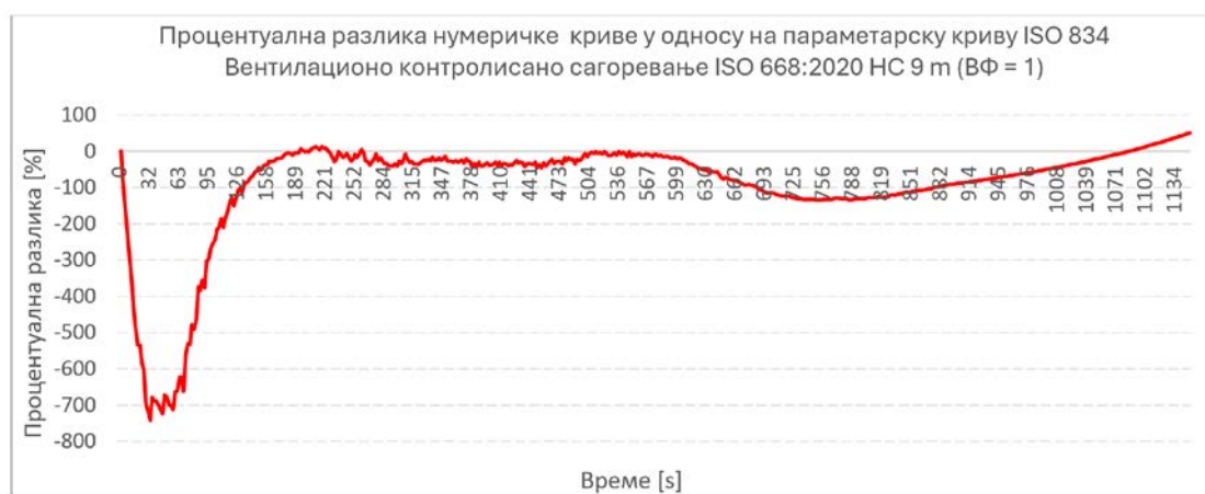
Слика 7.16 Процентуална разлика нумеричке пожарне криве у односу на параметарску пожарну криву, пожар контролисан вентилационим фактором ВФ = 1
