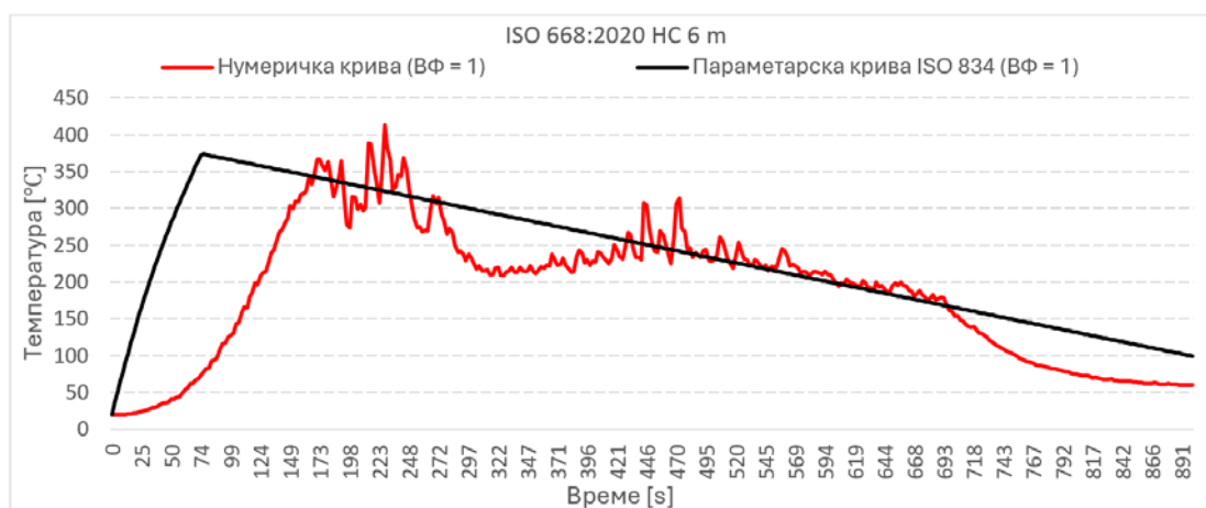
Слика 7.9 Нумеричка пожарна крива и параметарска пожарна крива, пожар контролисан вентилационим фактором VФ = 1
