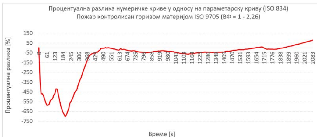
Слика 7.4 Процентуална разлика нумеричке пожарне криве у односу на параметарску пожарну криву (ISO 834), пожара контролисаног горивом материјом за средњу вредност ВФ = 1 - 2.26
