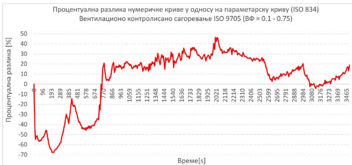
Слика 7.2 Процентуална разлика нумеричке пожарне криве у односу на параметарску пожарну криву (ISO 834), пожар контролисан вентилационим фактором за средњу вредност, VФ = 0.1 - 0.75
