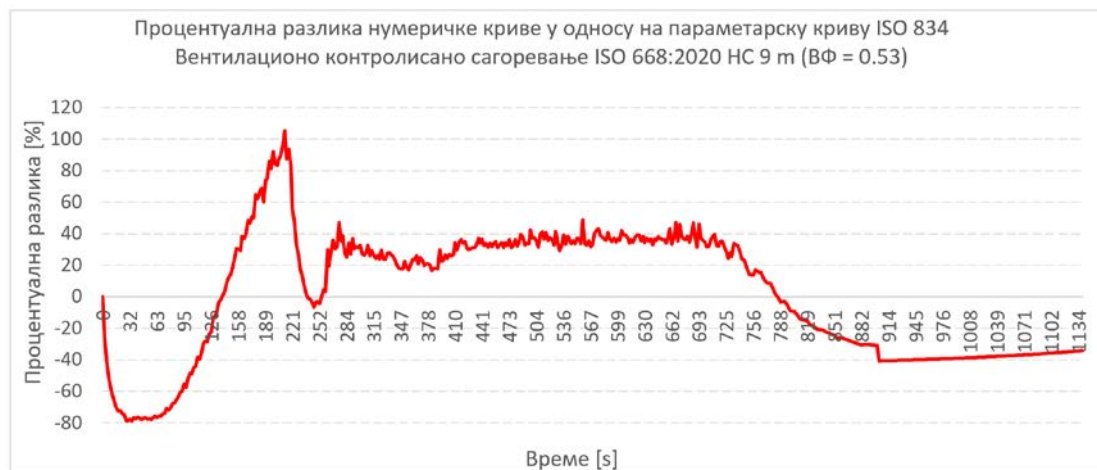
Слика 7.14 Процентуална разлика нумеричке пожарне криве у односу на параметарску пожарну криву (ISO 834), пожар контролисан вентилационим фактором V\Phi = 0.53
