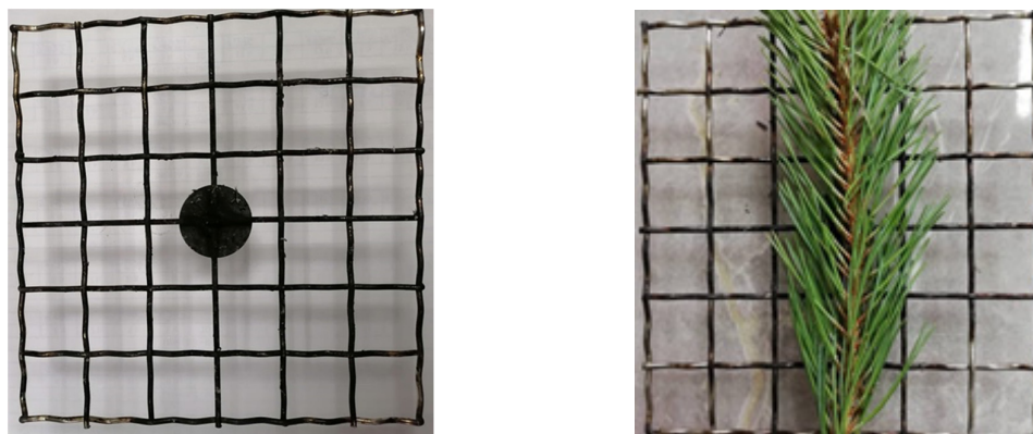
Слика 4.1. Носач узорка са постављеним узорком врсте P. nigra
