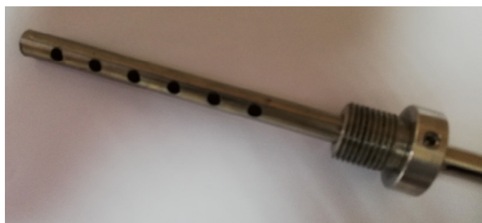
Слика 2.5. Изглед сонде за узорковање продуката сагоревања, израђена у складу са стандардом ISO/TS 21397
