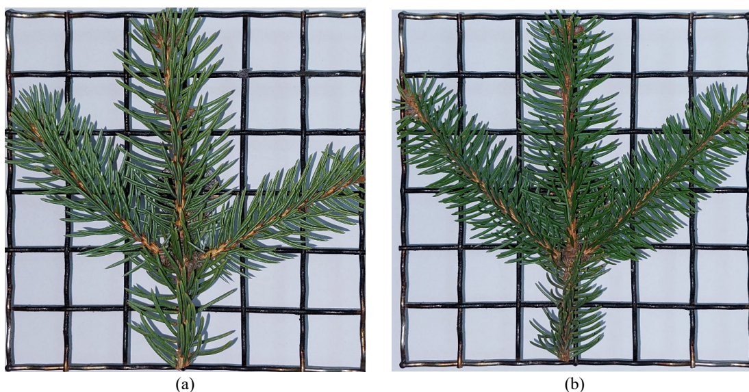
Слика 3.3. Специјално дизајниран носач узорка са постављеним узорцима: (а) гранчица јеле ( A. alba ); (б) гранчица смрче ( P. abies )
