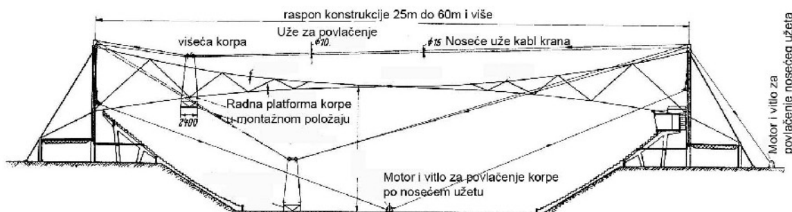
SLIKA II-3 Šema kabl-kрана sa radnom platformom za montažu, kontrolu i merenja na kablovskim rešetkama (primenjeno na Klizalištu u Johaneshovu u Švedskoj)
