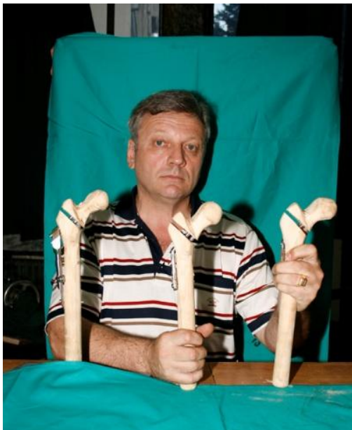
Slika 49. Pripremljeni modeli butne kosti za ispitivanje otpornosti implantata na dejstvo aksijalne sile
