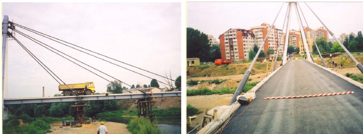
Slika 5.4.29 Dinamičko ispitivanje mosta: a) vozilo na mostu b) postavljena prepreka
