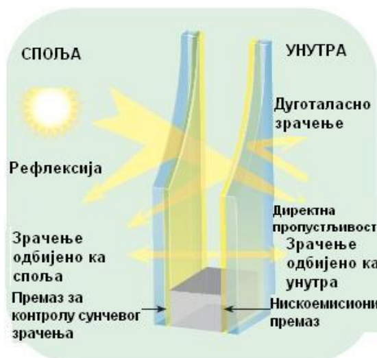
Сл. 4.3.3.3 Двоструко стакло са премазом за контролу сунчевог зрачења на #2 и нискоемисионим премазом на #3 (извор илустрације: [118]).
