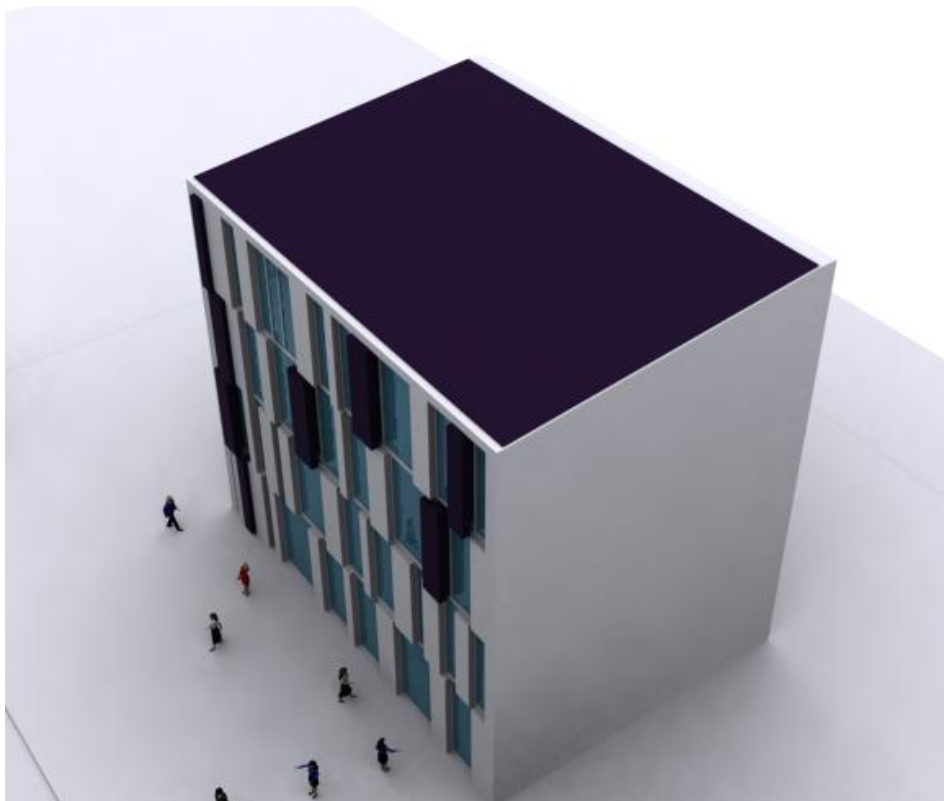
Сл. 5.2.3 Аксонометријски приказ интегрисане инсталације фотонапонске електране у кров радног модела.
