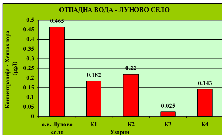
Слика 10.77. Графички приказ концентрација хептахлора ( \mu\text{g/l} ) у води ЗЗ „Луново село”, пре и после пропуштања кроз колоне експерименталног модела
