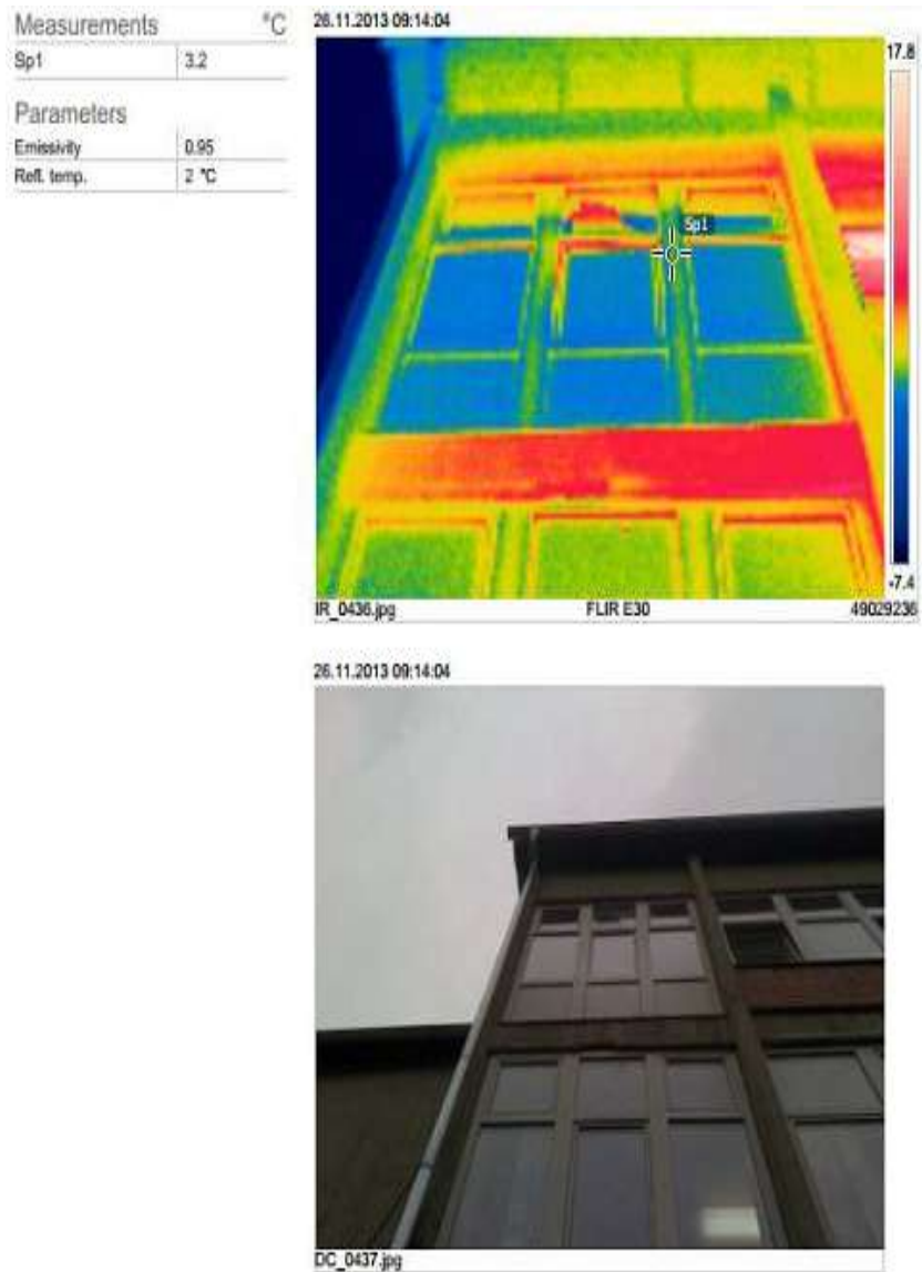
Слика 3.8 Термална слика омотача учионице
