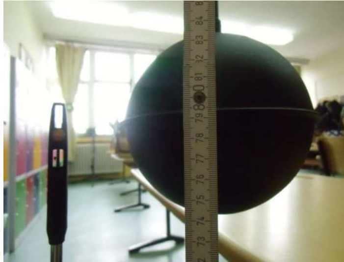
Слика 3.15 Инструменти TESTO-Globe и TESTO-Hotwire anemometer
