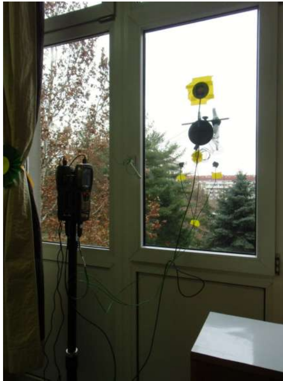
Слика 3.11 Мерење U вредности елемената објекта школе
