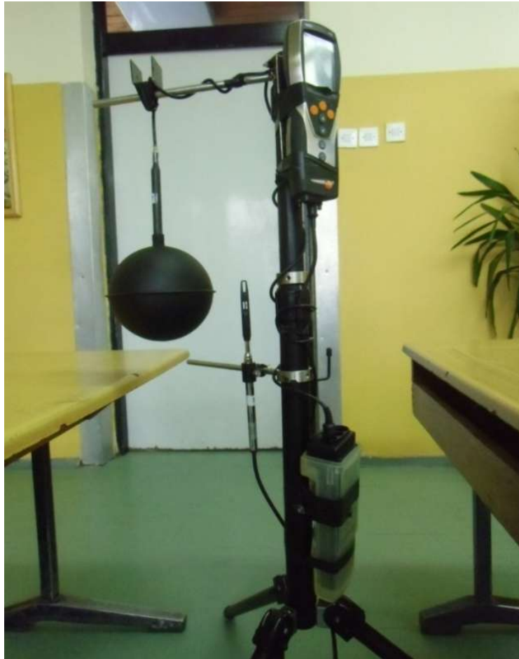
Слика 3.20 Мерење и одређивање локалног PMV
