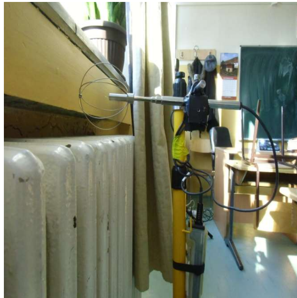
Слика 3.16 Инструмент TESTO-Turbulent сензор за мерење интензитета турбуленције
